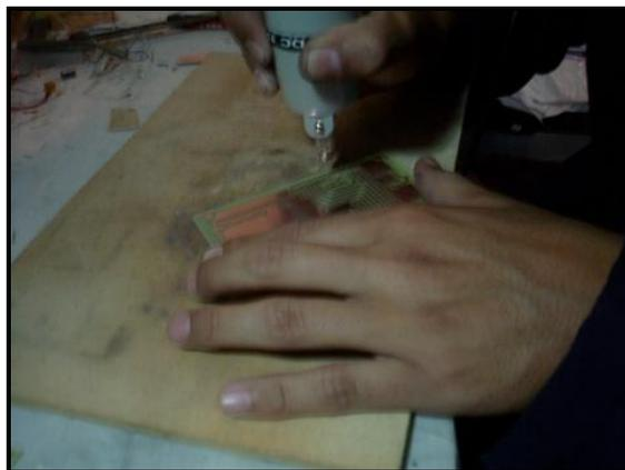
**4.20. Limpieza y perforación de la placa metálica.**
