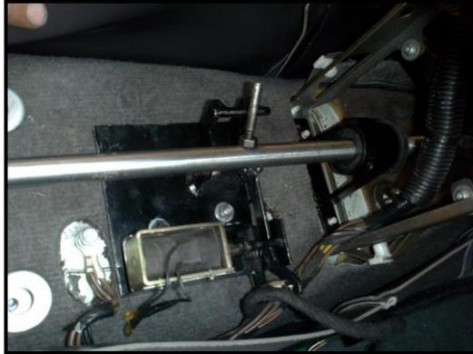
**Figura 4.8. Montaje del mecanismo de 1era, 2da y Reversa.**
