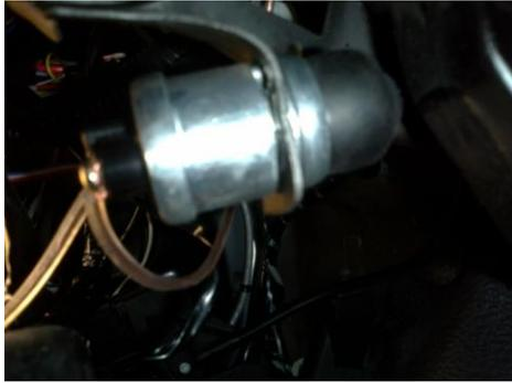
**Figura 4.30.**Ubicación de un pulsador en el pedal del embrague.
