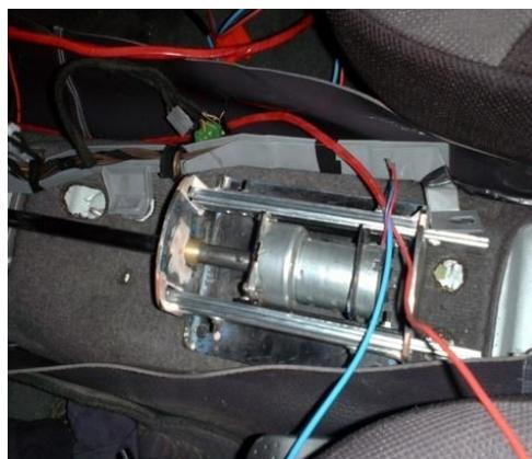
**Figura 4.13.** Conexión eléctrica de los motores.
