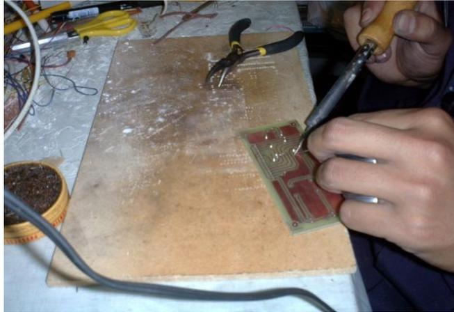
**Figura 4.21. Suelda de los componentes electrónicos.**
