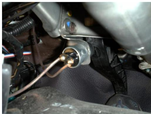
**Figura 4.25. Ubicación del pulsador en el pedal del embrague.**
