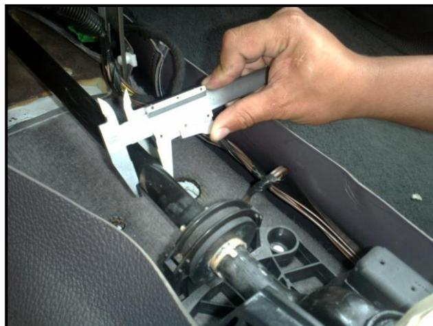
Figura 3.12. Medición del vástago de la palanca principal.
