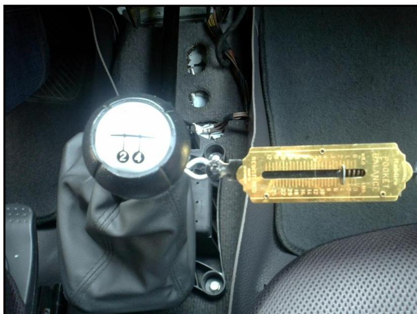
Figura 3.8. Medición del par para realizar el giro.
