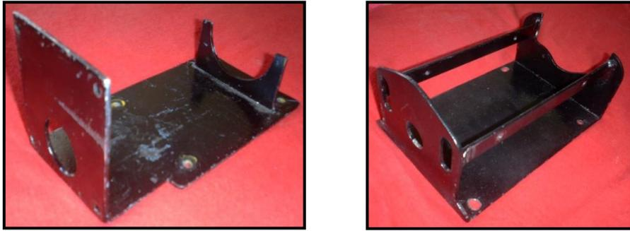
**Figura 4.5. Bases de los motores de acuerdo al diseño establecido.**
