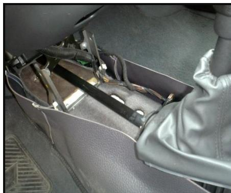
**Figura 4.2. Desmontaje de la carcasa plástica de protección de la Palanca de cambios.**
