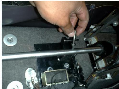
**Figura 4.29. Mecanismo de control para el cambio a la velocidad de Retro, ensamblado al interior del vehículo.**
