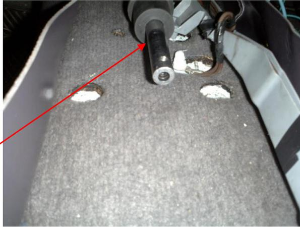
**Figura 4.10. Montaje de la varilla principal del mecanismo**
