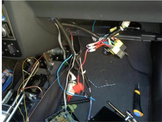
**Figura 4.14. Conexión eléctrica de los motores a sus relés.**
