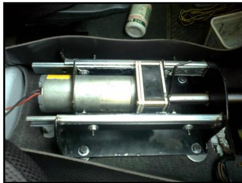
**Figura 4.6. Motores fijados a las bases.**
