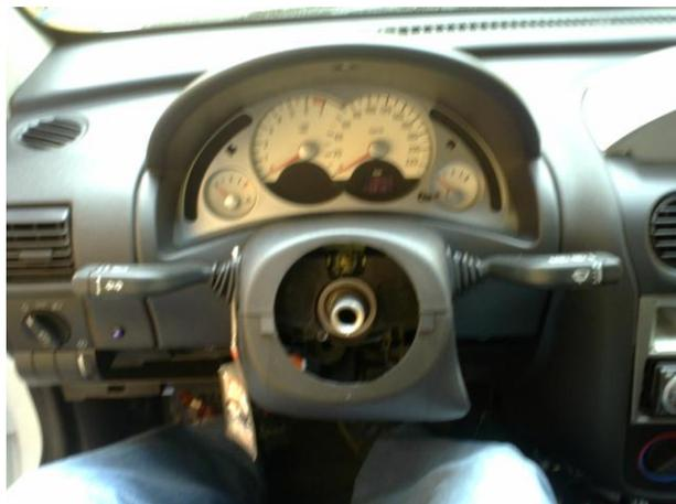
**Figura 4.22. Desmontaje de volante del vehículo.**
