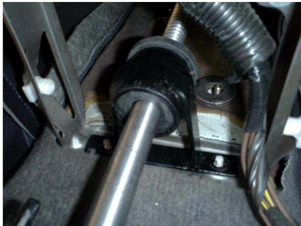
**Figura 4.9. Montaje del soporte del eje principal.**
