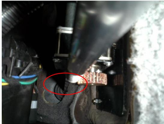
**Figura 4.12.** Se asegura la varilla al mecanismo de cambio de marchas
