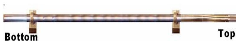
fig. 2.5.- Eje del motor eléctrico
