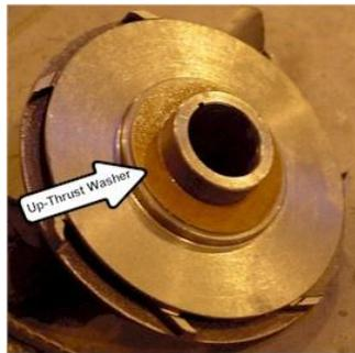
fig. 2.11.- Impulsor de flujo Radial
