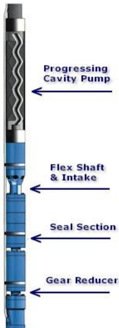
Fig. 1.10.- Sistema de Bombeo por Cavidad Progresiva
