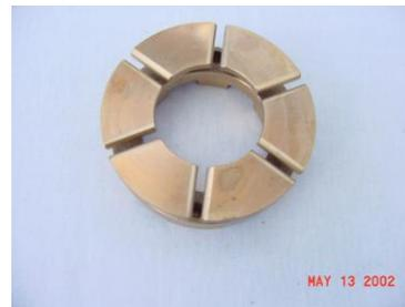
fig. 2.8.- Zapata sólida
