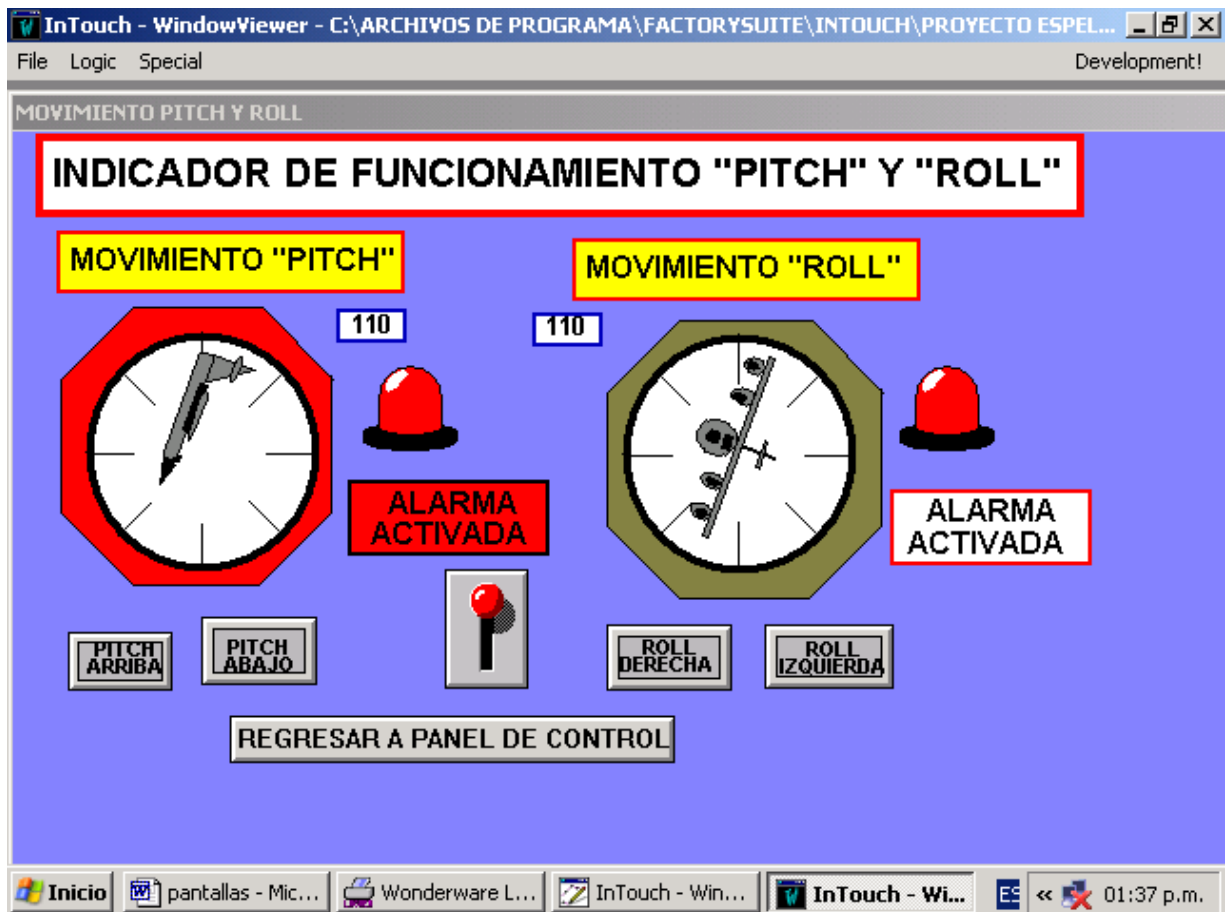
Figura 3.20 “MOVIMIENTO PITCH Y ROLL” con avión con ángulo de giro mayor a 90 grados
