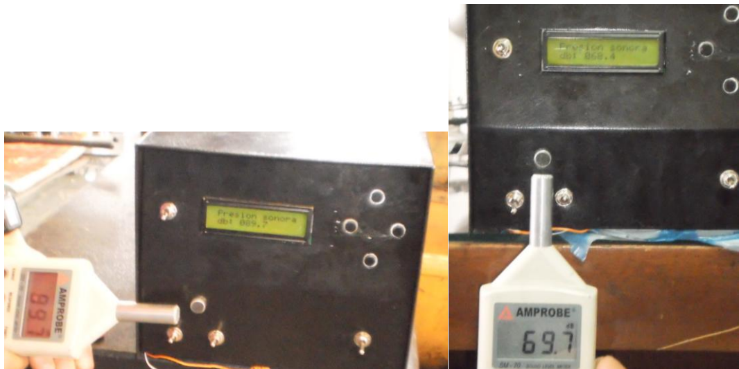
Figura 2. Pruebas que el Sonómetro construido tiene la misma referencia que el Sonómetro Patrón
