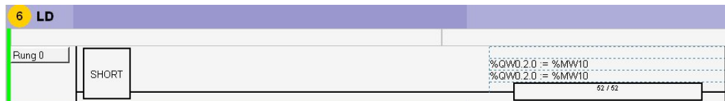
Figura 4.6: Valor de Frecuencia para el variador seteada desde TWIDO SUITE
