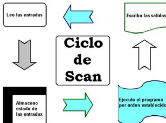
Figura 1.46: Flujo del funcionamiento de un PLC
