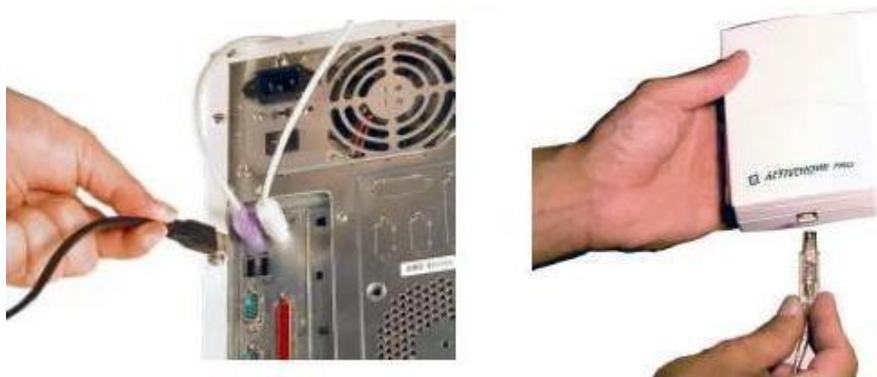
**Fig. 3.1: Conexión del transceiver a la estación base**
