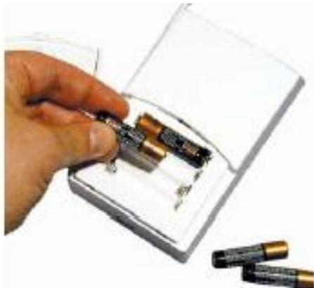
**Fig. A.2: Colocación de Baterías al PLC transceiver**
