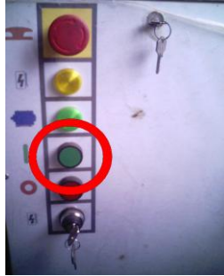
Figura N° 4.1. Tablero de control. Detalle del botón de encendido.
