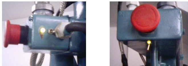
Figura N° 4.6. Tablero de control. Detalle del botón de apagado.
