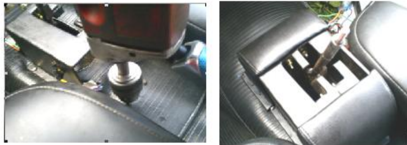
Figura 3.59. Instalación de los sensores de posición de marcha.
