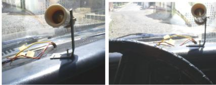
Figura 3.61. Montaje de los shift lite.
