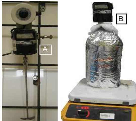
Figura 2.14 A) Agitador mecánico B) Hidrólisis piloto
