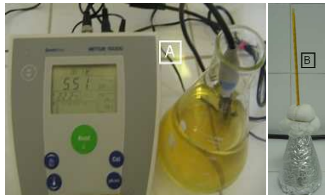
Figura 2.16 Medición de A) pH B) Temperatura.
