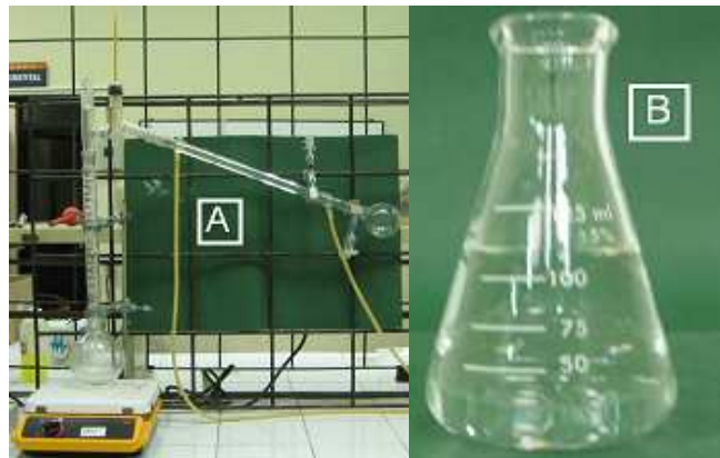
Figura 2.12 A) Equipo de destilación fraccionada B) Destilado.
