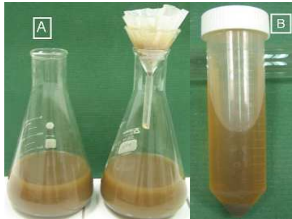
Figura 2.10 Muestra A) Filtrada B) Centrifugada.
