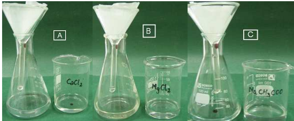
Figura 2.13 Deshidratación A) \text{CaCl}_2 B) \text{MgCl}_2 C) \text{NaCOOCH}_3 .
