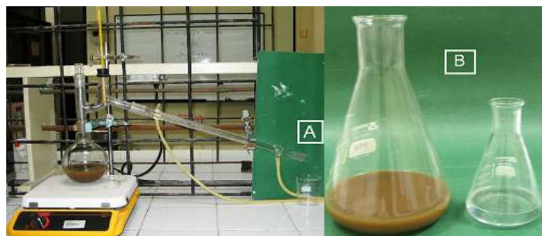
Figura 2.11 A) Equipo de destilación simple B) Destilado.
