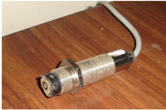
Figura 2.3 Sensor de proximidad utilizado por la Carda C4
