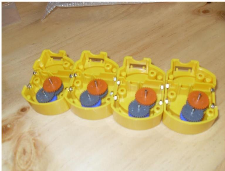
ANEXO 1: 8 Ensamblado del sistema de engranes con las piezas p4, p5, p6 y p7 de cada motor.
