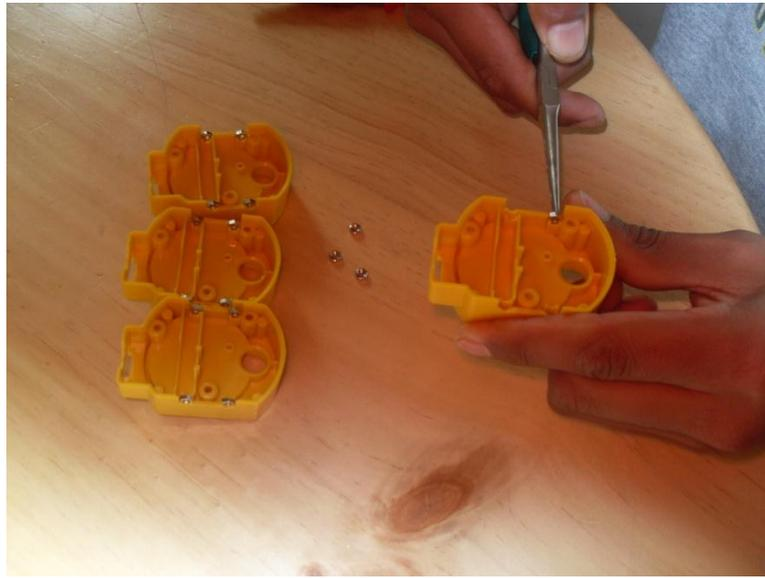
ANEXO 1: 3 Colocación de las tuercas p18 en la pieza a2
