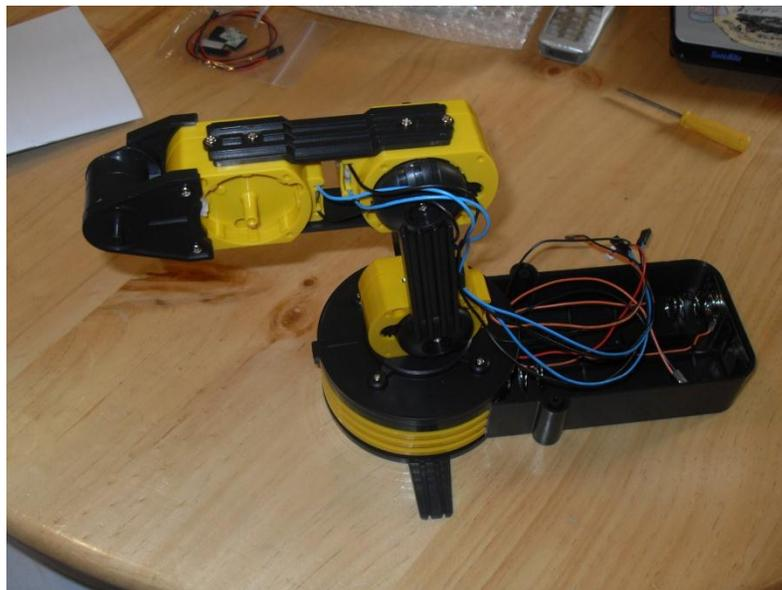
ANEXO 1: 16 Ensamblaje ensamble de las piezas M2 Y M3 en el brazo robótico.
