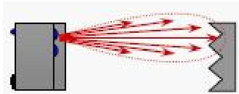
Figura 1. 14 Sensor de Proximidad Infrarrojo Tipo Réflex
