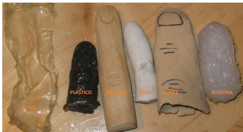
Figura 2. 68 Materiales para el diseño de la piel robótica
