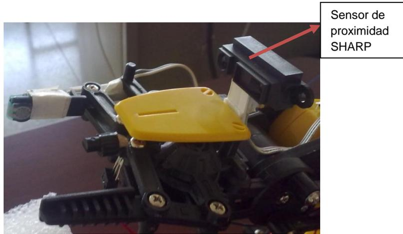
Figura 2. 53 Sensor de proximidad en el brazo robótico.
