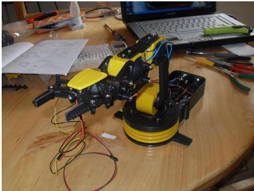
ANEXO 1: 20 Colocación del Gripper en el brazo robótico.
