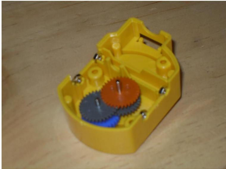
ANEXO 1: 7 Ensamblado del sistema de engranes con las piezas p4, p5, p6 y p7
