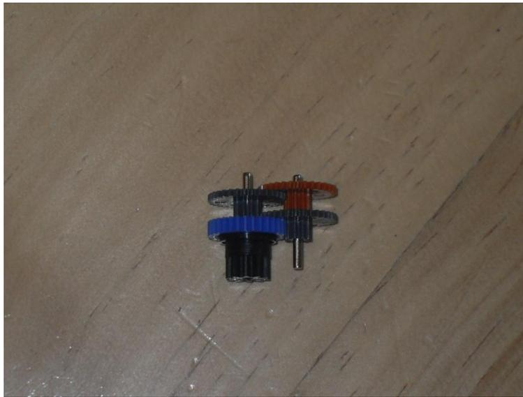
ANEXO 1: 6 Ensamblado del sistema de engranes.
