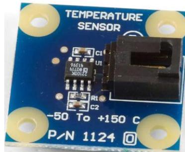
Figura 1. 10 Sensor de Temperatura de Precisión
