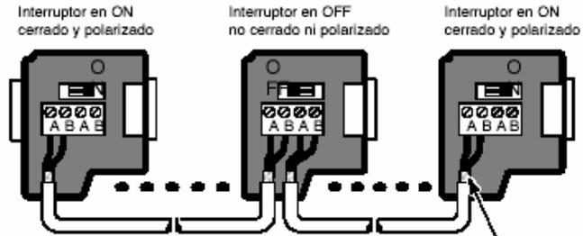
Blindaje del cable: aprox. 12 mm deben hacer contacto con la guía de metal en todos los puntos.
