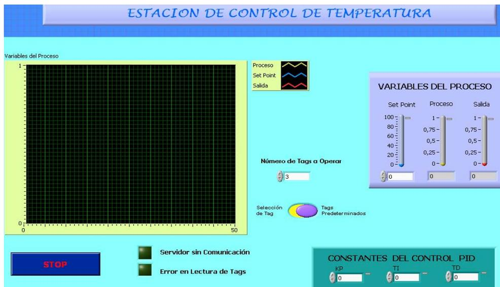
Figura 5.24 Panel frontal del control del Proceso de Temperatura
