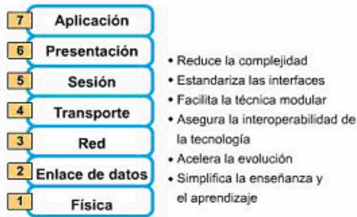
Figura 4.3 Modelo de referencia OSI
