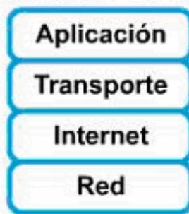
Figura 4.5 Protocolo TCP/IP.
