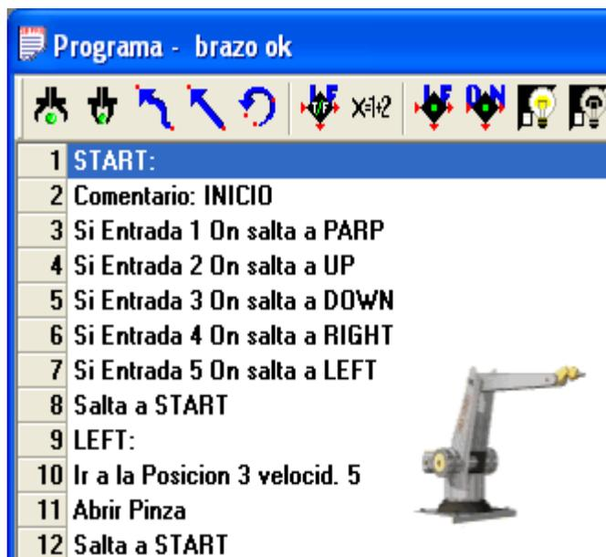
**Figura 3.14** Líneas de programa para el movimiento ocular hacia la izquierda
