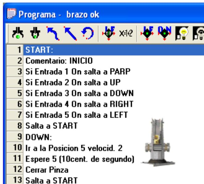
**Figura 3.12 Líneas de programa para el movimiento del ojo hacia abajo**
