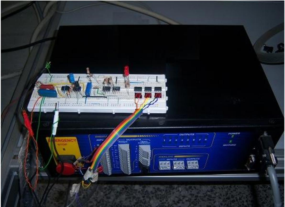
**Figura 2.18 Manejo de las entradas digitales del controlador**
