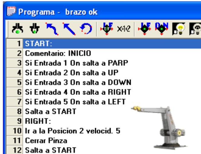
**Figura 3.13** Líneas de programa para el movimiento ocular hacia la derecha
