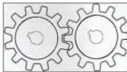
**Figura 1.3 Transmisión de engranajes**
