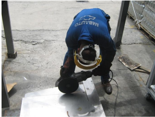
Figura 4.7 Corte de Placas para las aspas
