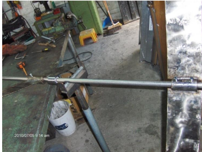
Figura 4.13 Montaje de las aspas al eje
