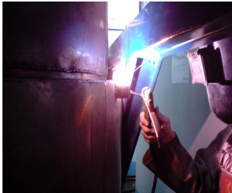
Figura 4.4 Suelda de boquillas y tubos
