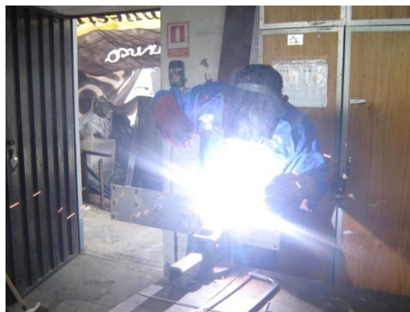
Figura 4.10 Suelda de los filos del aspa
