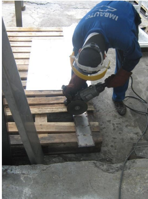
Figura 4.11 Corte de las aspas enteras en la mitad
