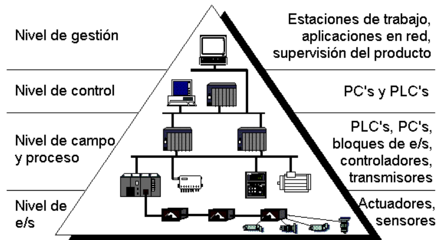
Figura Nº 1.7 Arquitectura de una Red de Campo
