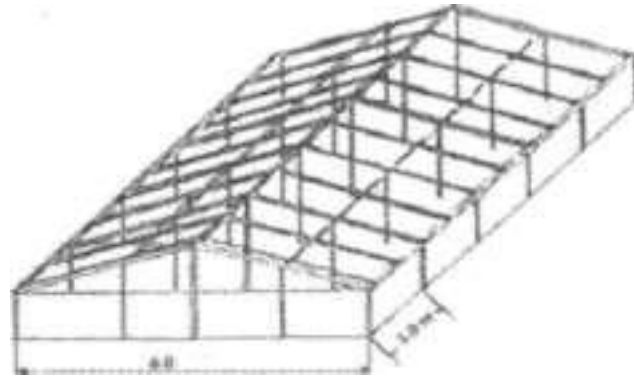
Figl.6. Gráfico de la estructura de un invernadero tipo Capilla.
