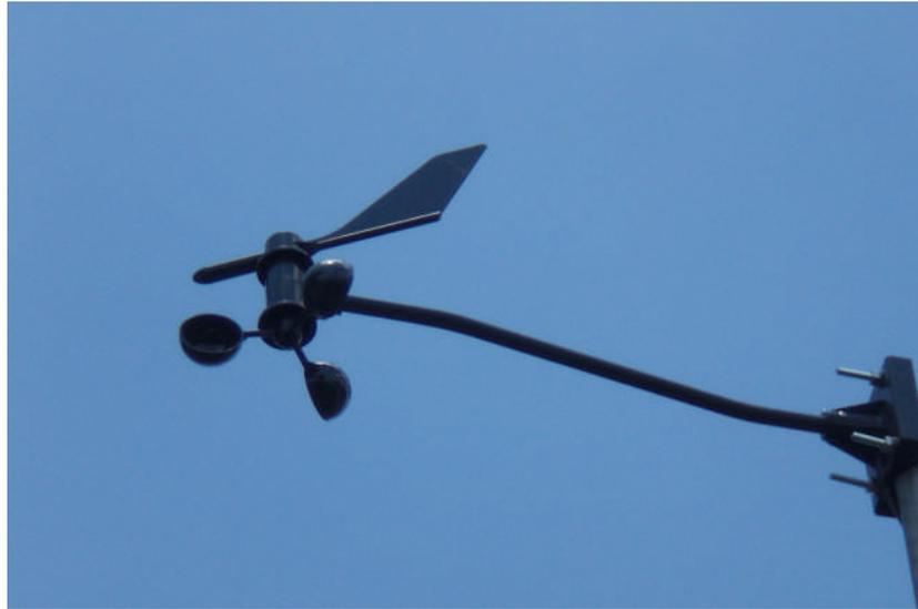
**Figura 3.9 Sensor de dirección de viento**
