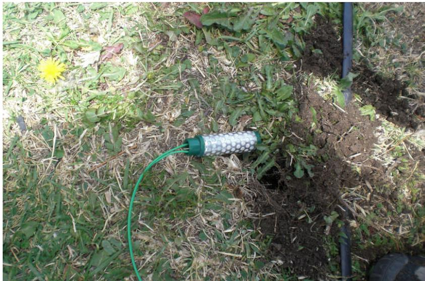
**Figura 3.10 Sensores de humedad de suelo**
