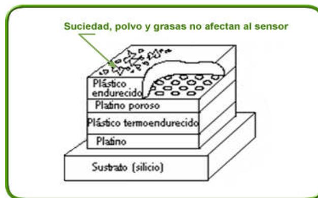
**Figura 1.33 Sensor capacitivo**
