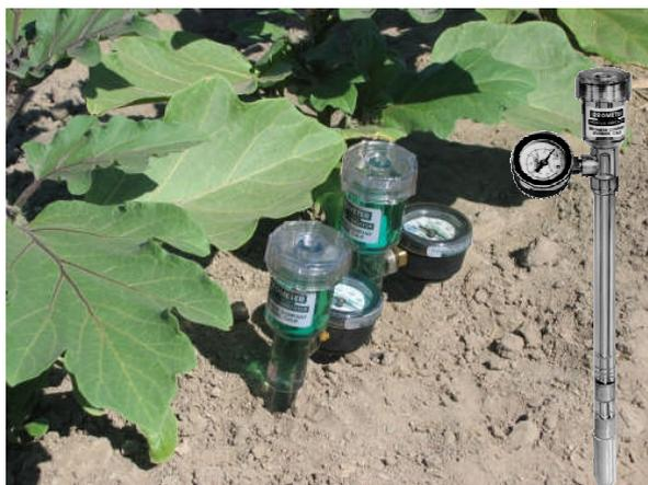
**Figura 1.34 Tensiómetro**
