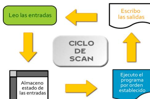
**Figura 1.26 Ciclo de funcionamiento del PLC**
