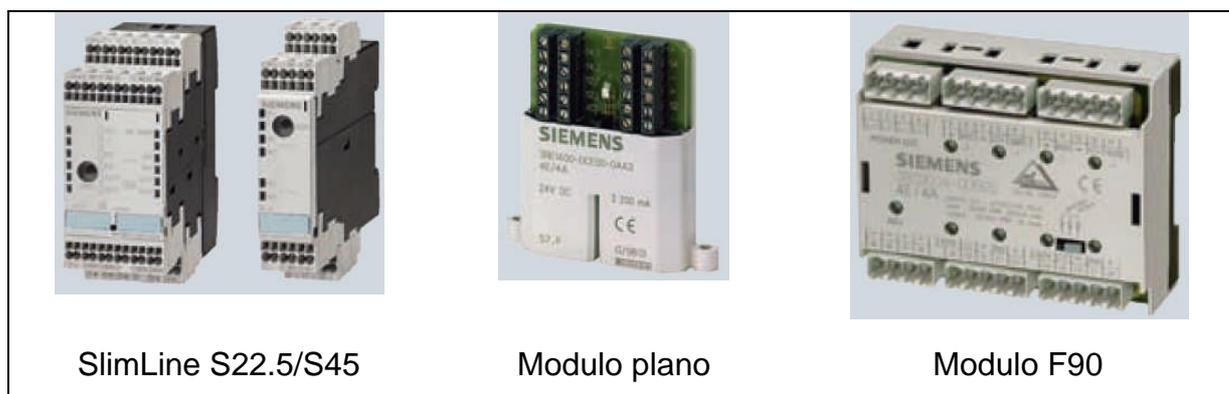
**Figura 2.13 Esclavos digitales para tablero**
