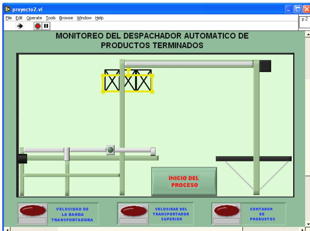
**Figura 4.18 Elevación del brazo neumático con los productos terminados a la parte superior del prototipo**
