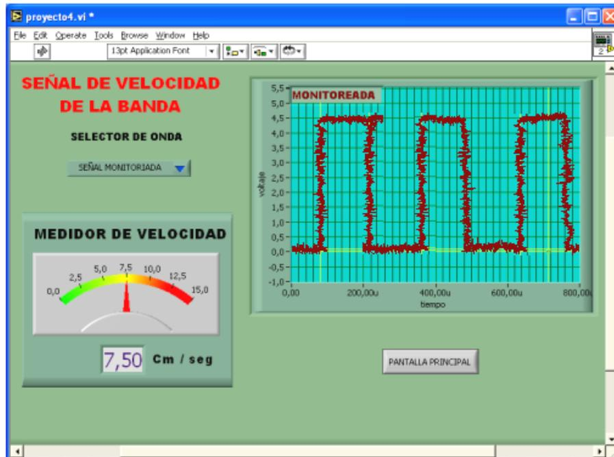
Figura 4.25 Forma de onda monitoreada del sensor de la banda transportadora
