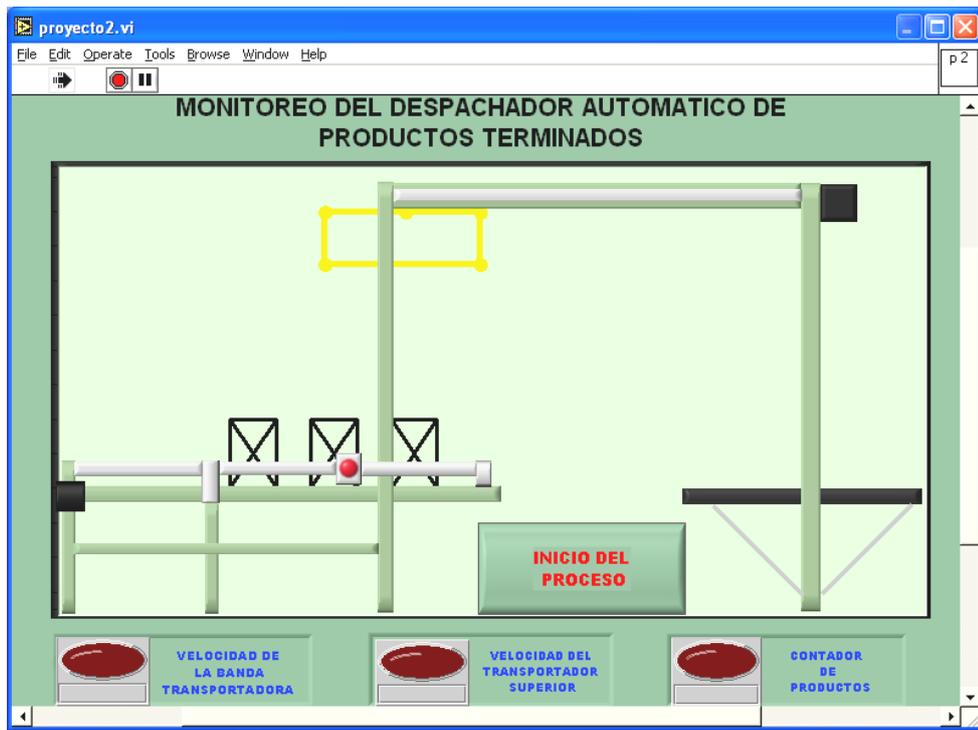
Figura 4.16 Conteo de productos mediante el sensor óptico
