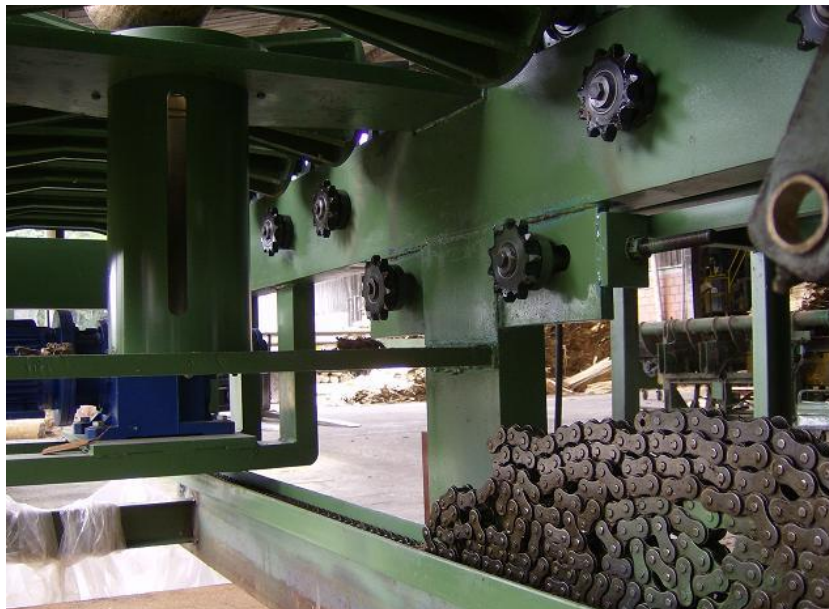
Fig. 2.10 Sistema de transmisión por medio de piñones y cadenas
