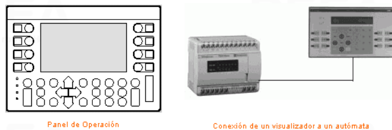
Fig. 2.1.4.9. Ejemplos de Conexión a Periféricos
