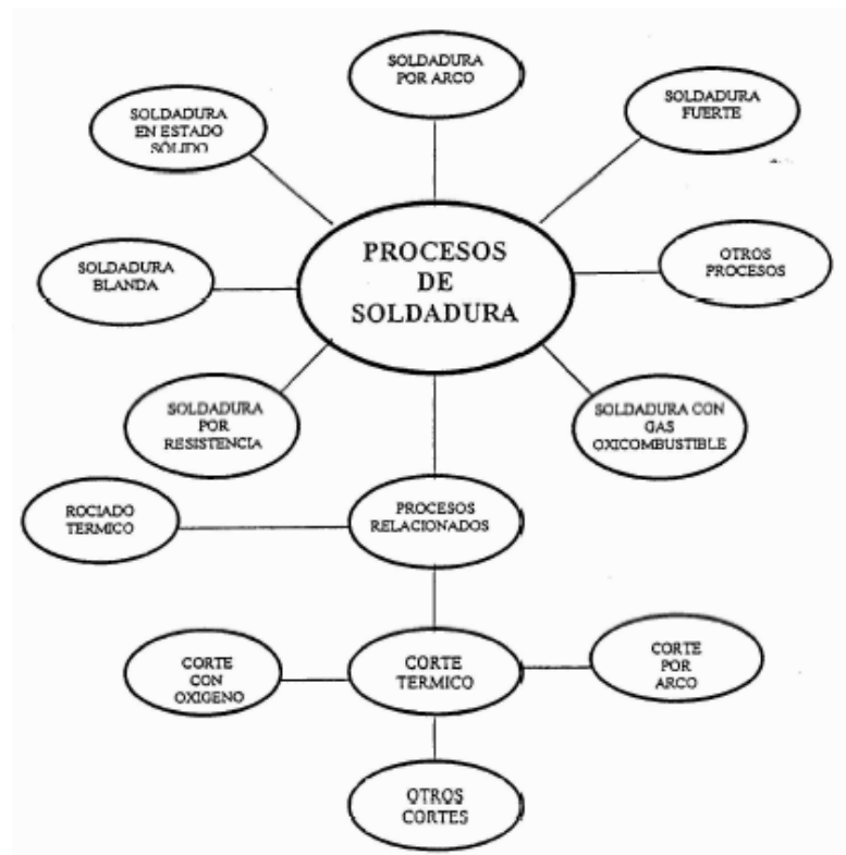
Carta maestra de los Procesos de Soldadura (de acuerdo con la Norma ANSI/AWS A3.0-94, "Términos y Definiciones Estándar de Soldadura")
