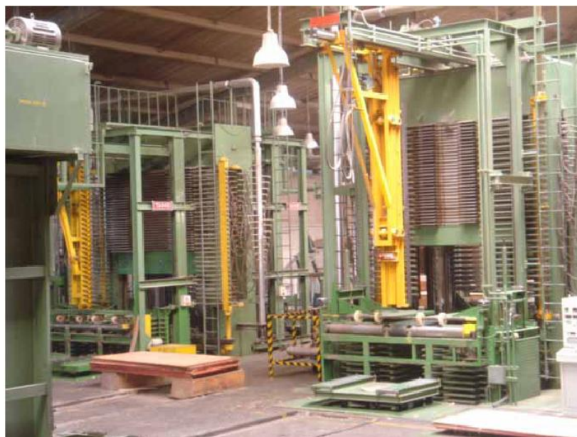
Fig. 1.13 Prensado del tablero.
