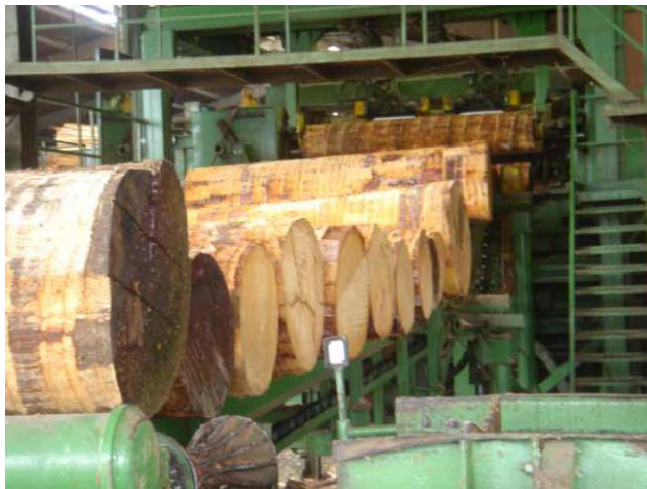
Fig. 1.9 Transporte vertical al torno
