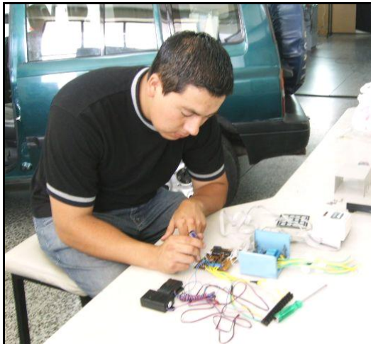
Figura 3.68 Conexión final, soldado y aseguramiento del circuito.
