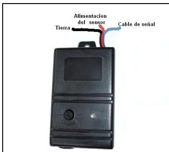
Figura 3.21 Sensor de rotura de vidrios y sus cables de conexión.
