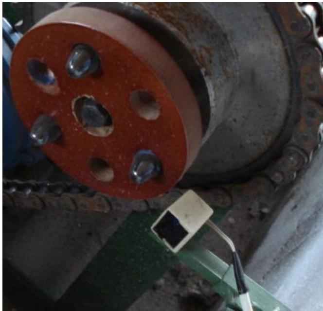
Figura 3.3 Ubicación de los imanes acompañados con los sensores
