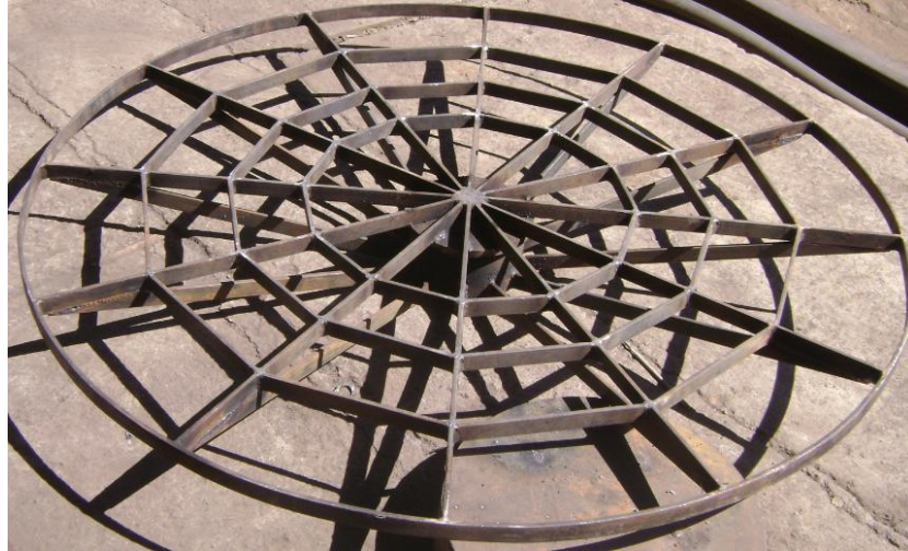
Figura 3.2 Estructura del plato giratorio construida.
