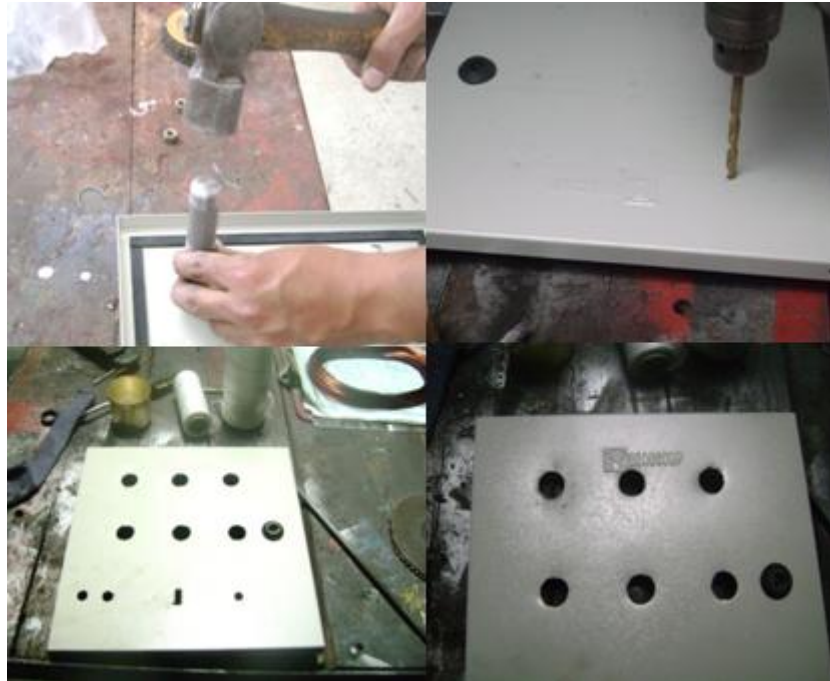
Figura 3.12. Orificios en el gabinete de control
