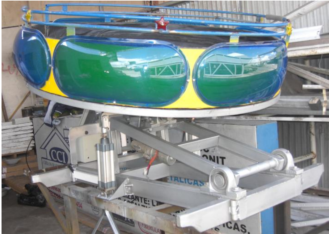
Figura 3.7. Ensamble total del juego mecánico tagada.
