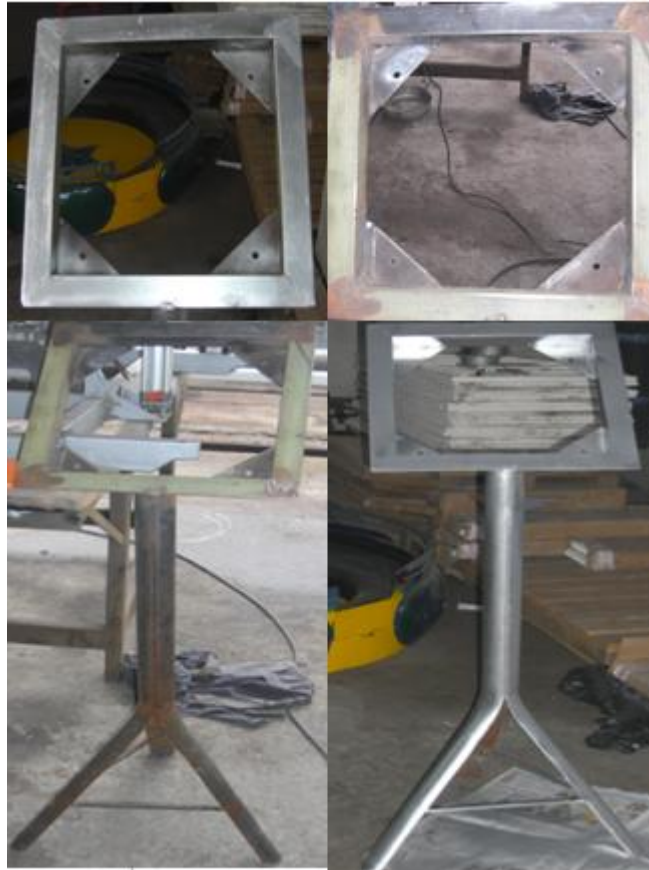
Figura 3.11. Trípode del tablero de control.
