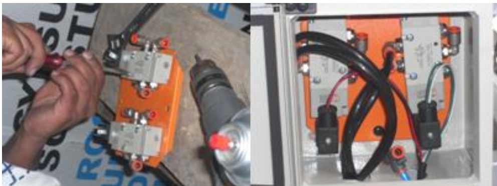
Figura 3.16. Empotrado de las electroválvulas.
