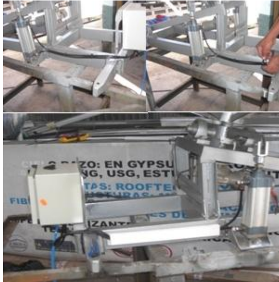
Figura 3.17. Conexión de las mangueras de presión.
