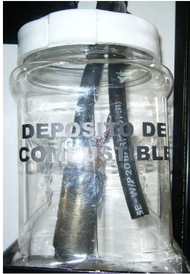
Figura 4.7 Deposito de combustible.
