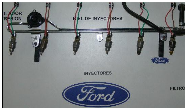
Figura 5.3 Riel de Inyección
