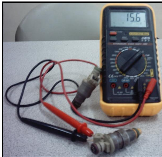
Figura 4.10 Medición de resistencia del inyector
