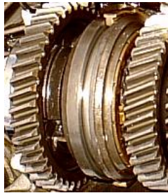
Gráfico 156 (Conjunto de sincronizados de primera y segunda velocidad)
