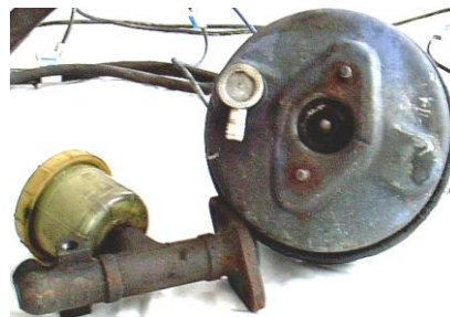
Gráfico 190 (Bomba y servofreno en pésimo estado)
