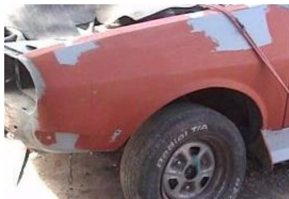
Gráfico 63 (Aplicación del aparejo o segunda capa de fondo en el guardafango)
