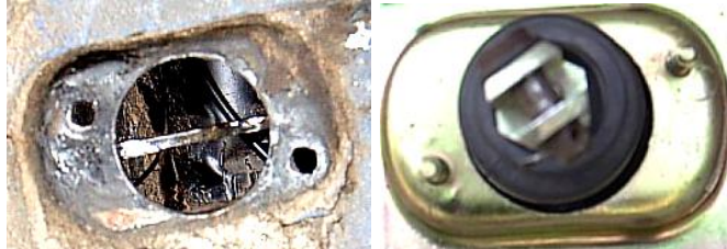
Gráfico 192 (Colocación de la bomba y servofreno en la carrocería)
