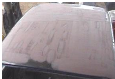
Gráfico 56 (Superficie lijada del techo del Renault 12 a restaurar)
