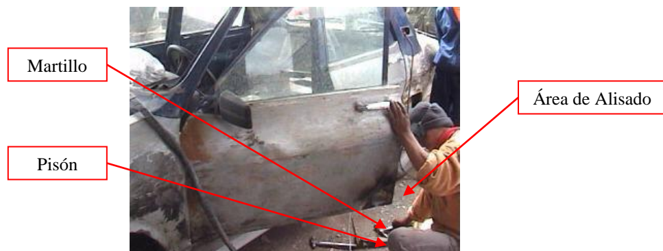
Gráfico 44 (Operación de Alisado de una puerta)
