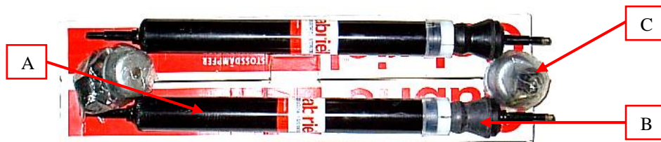
Gráfico 119 (Conjunto de piezas que conforman los amortiguadores delanteros)
