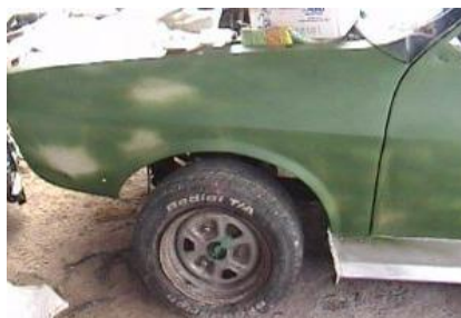
Gráfico 58 (Imprimación o primera capa de fondo en el guardafango delantero izquierdo)
