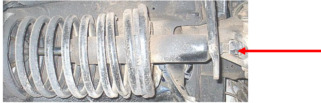
Gráfico 97 (Buje de unión entre el brazo de control superior con el amortiguador)
