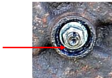
Gráfico 176 (Tuerca central que sostiene al tambor de freno)
