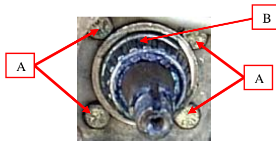
Gráfico 180 (Elementos que sostienen al plato porta freno)
