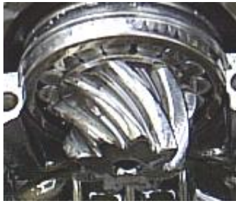
Gráfico 151 (Piñón de Ataque a la corona del el eje secundario)
