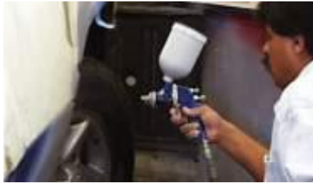
Gráfico 76 (Aplicación de la primera capa de pintura al Renault 12)
