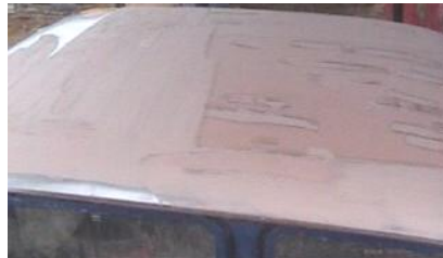
Gráfico 54 (Aplicación de la primera capa fina de Masilla en el techo del vehículo)
