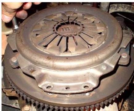
Gráfico 141 (Extracción de los pernos del lado izquierdo que sostienen el plato de embrague)
