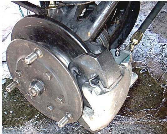
Gráfico 110 (Mordaza y manguera de freno montadas)
