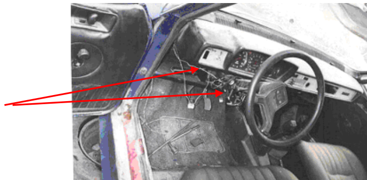
Gráfico 123 (Componentes y cables de mando en mal estado)
