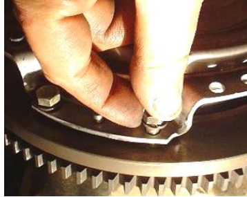
Gráfico 164 (Ajuste del plato de embrague contra el volante de inercia)
