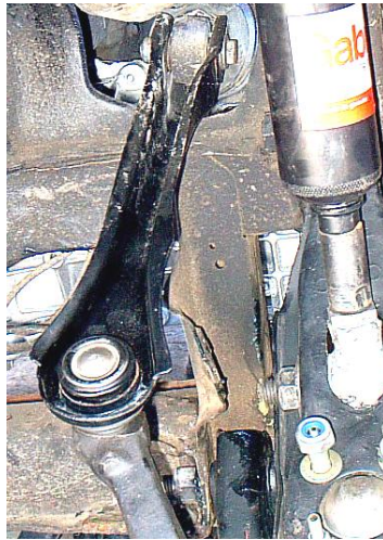
Gráfico 113 (Brazo de Control del lado derecho del Renault 12 restaurado)
