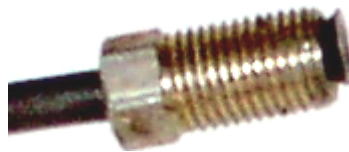
Gráfico 185 (Unión de las cañerías de freno reparada)
