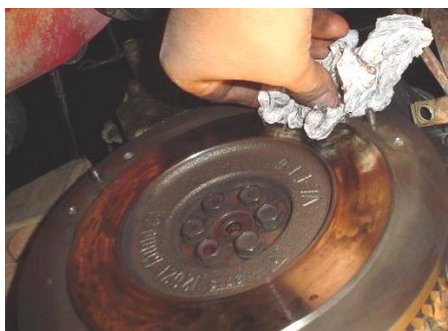
Gráfico 160 (Limpieza del volante de inercia con gasolina)
