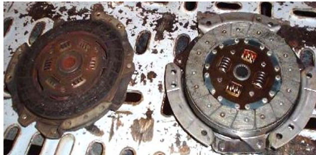
Gráfico 161 (Comparación del disco y plato de embrague nuevos con los dañados)
