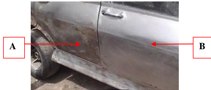
Gráfico 52 (Diferencia entre una superficie desengrasada y sin desengrasar)
