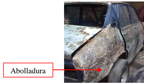
Gráfico 45 (Hueco en una plancha como consecuencia de una abolladura)
