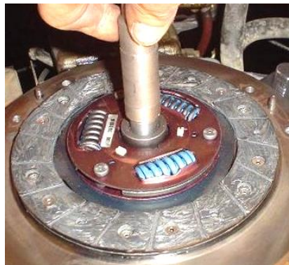
Gráfico 162 (Forma de centrar el disco de embrague)
