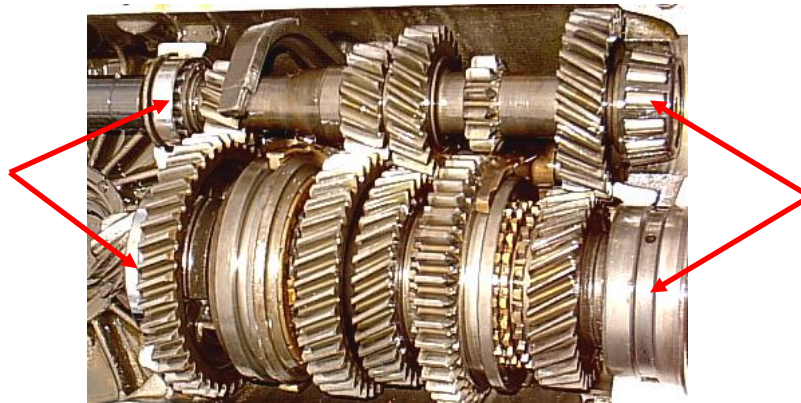
Gráfico 154 (Cojinetes de rodillos troncocónicos del eje primario y secundario)
