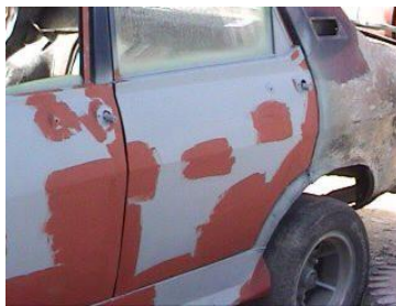
Gráfico 62 (Aplicación del aparejo o segunda capa de fondo en la puerta trasera izquierda)
