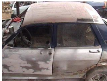
Gráfico 55 (Aplicación de la segunda capa gruesa de Masilla en el techo del vehículo)
