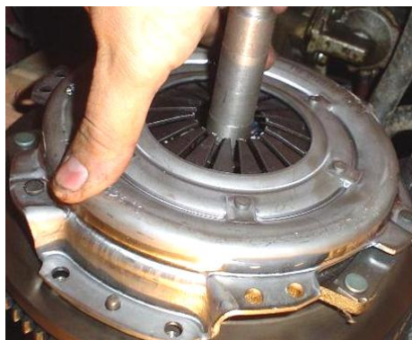
Gráfico 163 (Instalación del plato de embrague)
