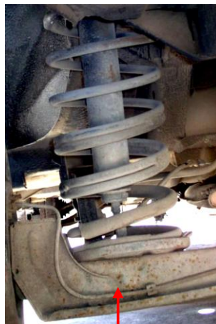
Gráfico 116 (Forma de aflojar la tuerca de unión del amortiguador al puente trasero)
