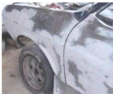
Gráfico 57 (Superficie lijada de la parte delantera derecha del Renault 12 a restaurar)
