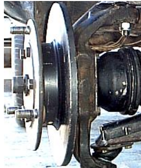
Gráfico 173 (Disco de freno montado en el soporte)
