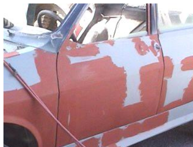
Gráfico 61 (Aplicación del aparejo o segunda capa de fondo en la puerta delantera izquierda)
