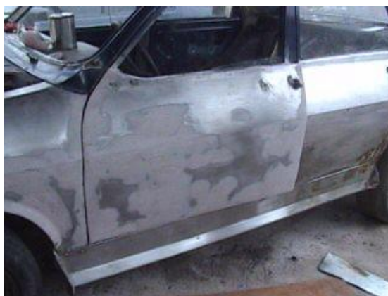
Gráfico 53 (Forma de aplicar la Masilla en una superficie)
