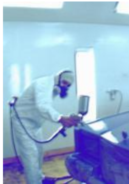
Gráfico 77 (Aplicación de la última capa de pintura al Renault 12)
