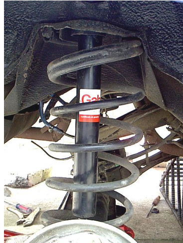
Gráfico 120 (Amortiguadores traseros instalados)
