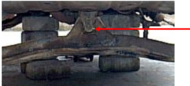
Gráfico 115 (Perno de unión del brazo de control medio y el puente trasero)
