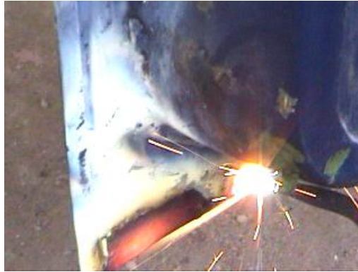
Gráfico 46 (Proceso de Deformación de la Plancha por Calentamiento)
