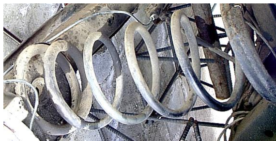
Gráfico 84 (Resorte Helicoidal para la suspensión trasera del Renault 12)
