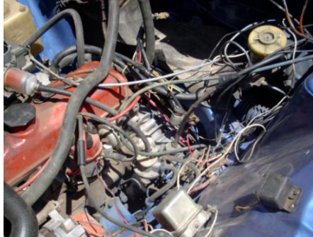
Gráfico 28 (Sistema eléctrico deteriorado)
