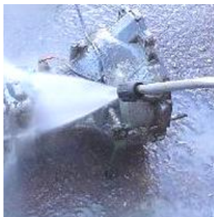
Gráfico 159 (Limpieza exterior de la caja de Velocidades)
