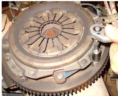
Gráfico 140 (Extracción de los pernos del lado derecho que sostienen el plato de embrague)
