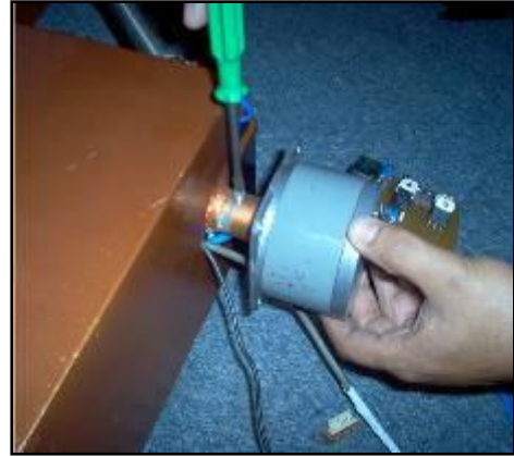
Figura. 3.18 Colocación del motor
