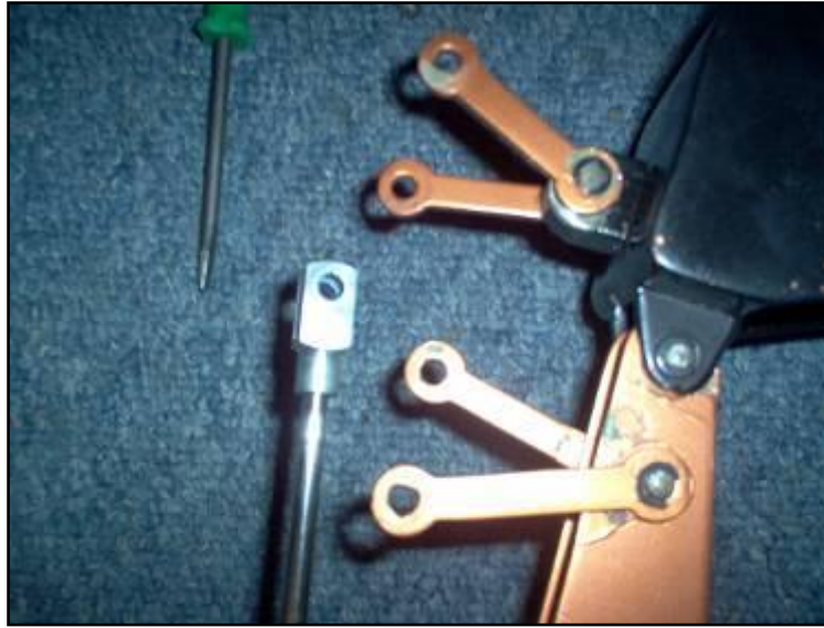
Figura. 3.7 Unión del cucharón con el cilindro
