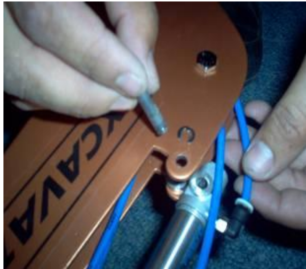
Figura. 3.10 Colocación del pasador del cilindro del aguilón
