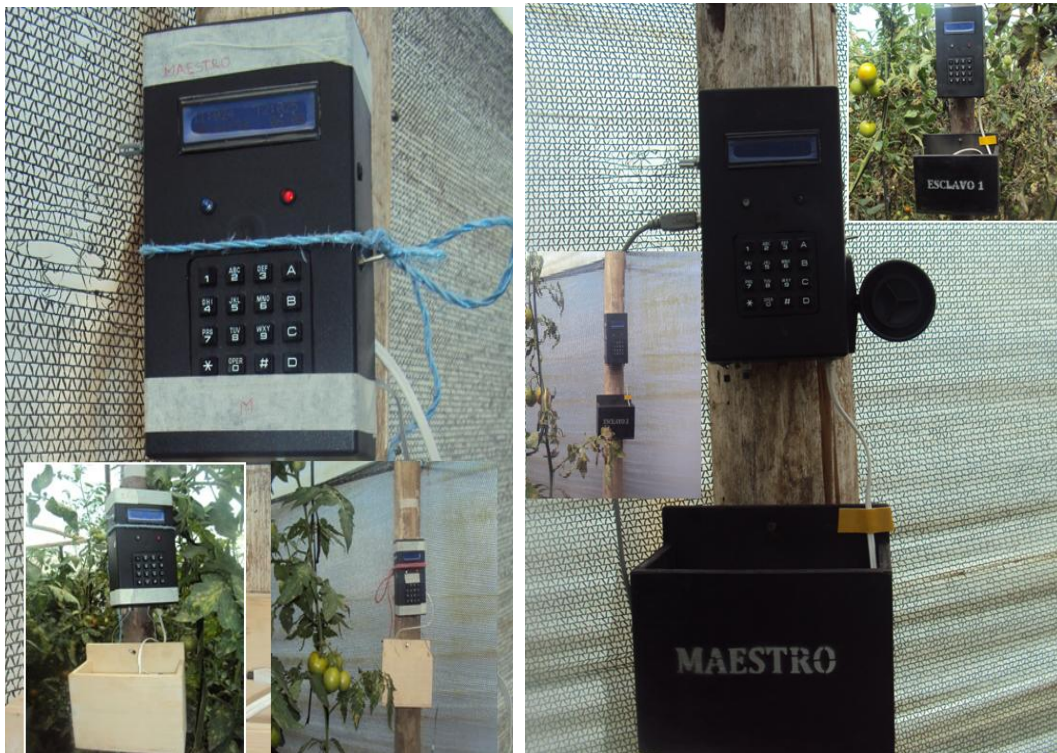
Figura 2.33.- Acoplamiento total del sistema en el invernadero
