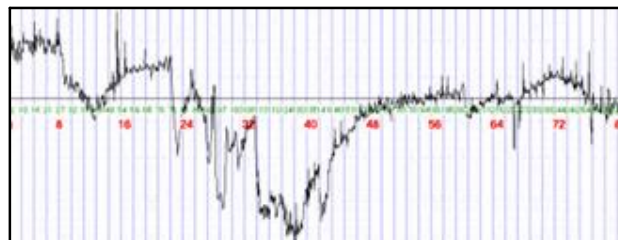
Figura 2.50: Señal con variaciones de la línea base
