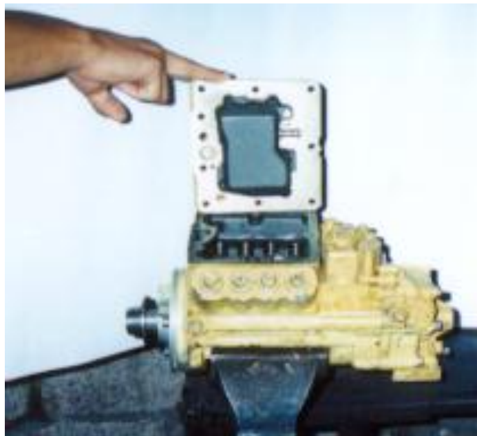
Fig. 5.1.- Desmontaje de la cubierta o tapa
