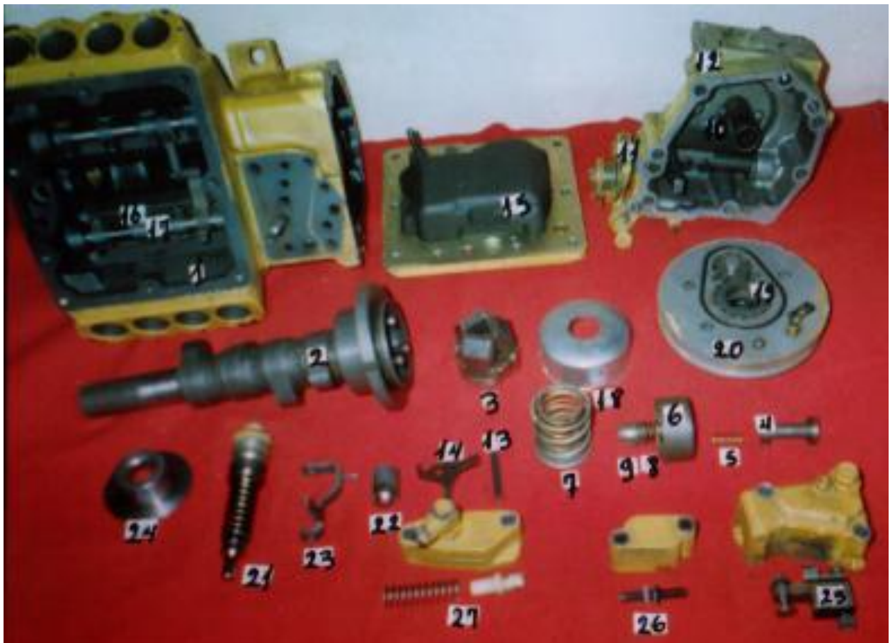
Fig. 2.1.- Constitución de la bomba de inyección CATERPILLAR
