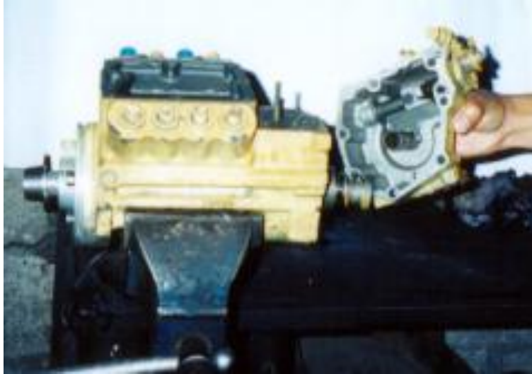
Fig. 5.4.- Desmontaje de la tapa del regulador
