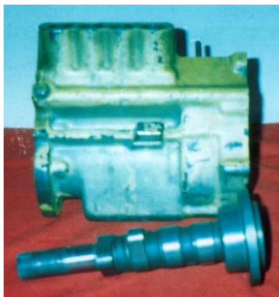
Fig. 5.14.- Desmontaje del árbol de levas
