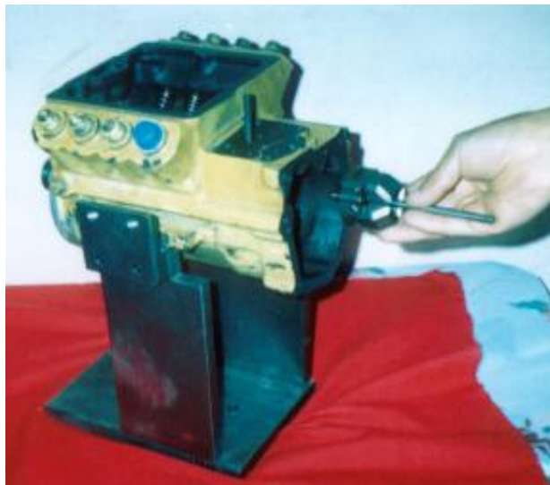
Fig. 5.9.- Desmontaje de los contrapesos del árbol de levas
