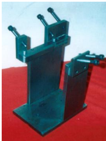
Fig. 4.5.- Base para la calibración de la bomba de inyección
