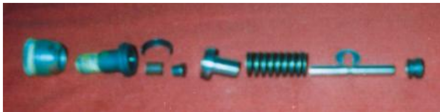
Fig. 5.16.- Despiece de los elementos de bombeo
