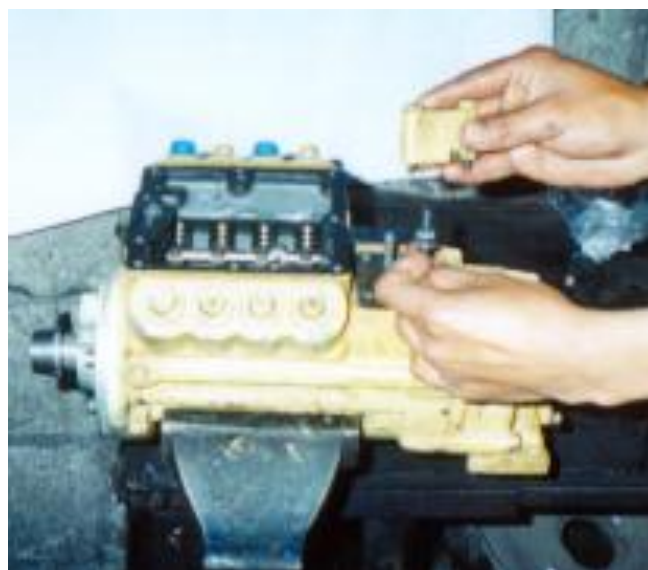
Fig. 5.3.- Desmontaje de la regulación del tope del acelerador
