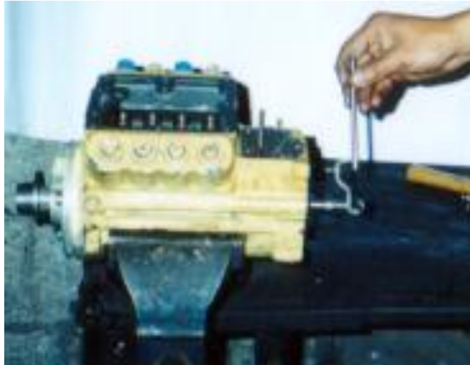
Fig. 5.6.- Desmontaje de la horquilla y el collar de empuje
