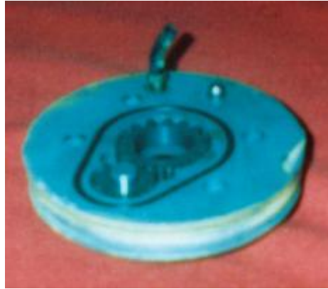
Fig. 3.2.- Bomba de transferencia o elevadora
