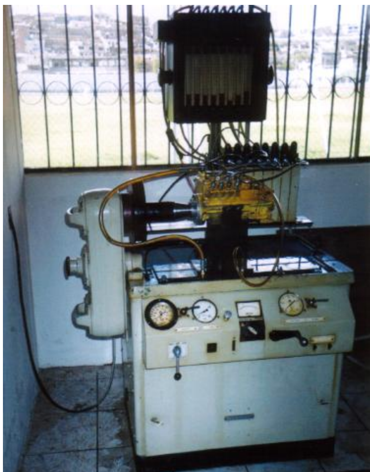
Fig. 6.2.- Montaje de la bomba en el banco
