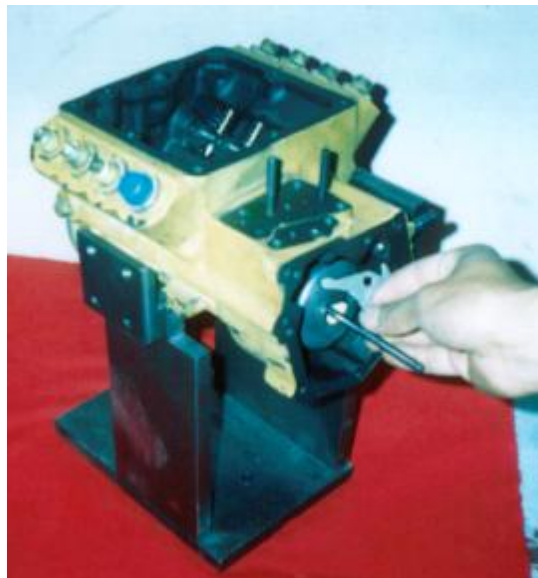
Fig. 5.7.- Desmontaje de la palanca de tope de carga
