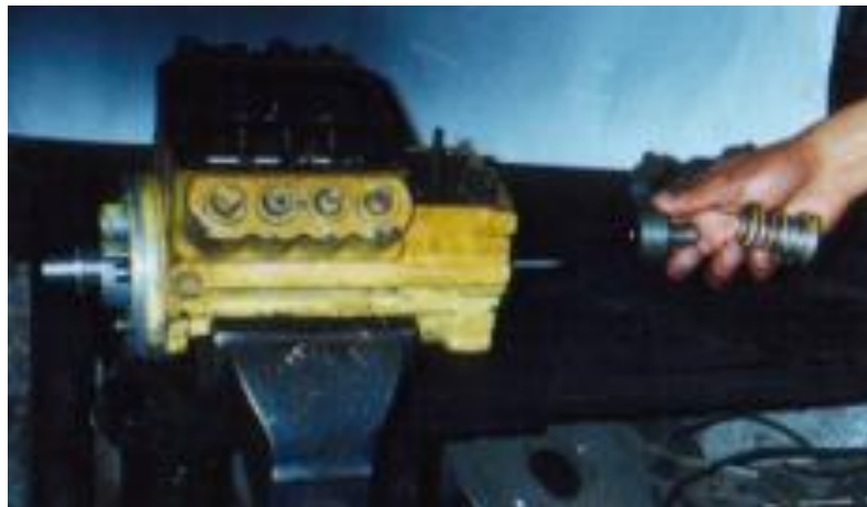
Fig. 5.5.- Desmontaje de los componentes del regulador
