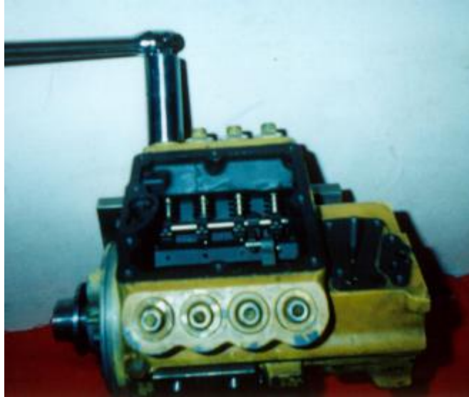
Fig. 5.10.- Desmontaje de los bujes de los elementos
