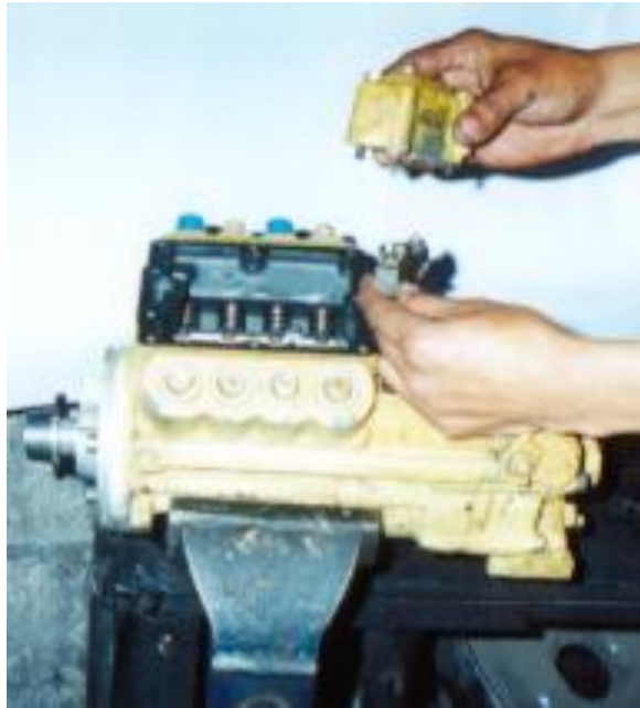
Fig. 5.2.- Desmontaje del limitador de velocidad del regulador
