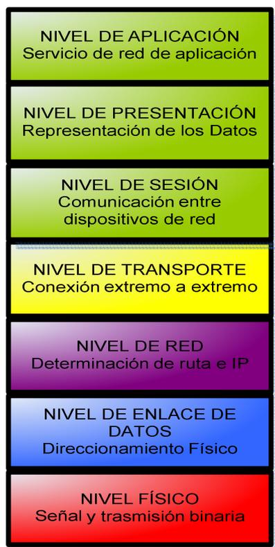
**Figura2. 1:** Modelo de Referencia OSI
