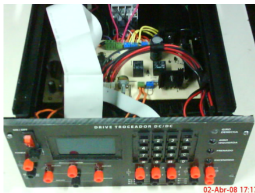
Fig. 2.18. Drive troceador DC/DC vista superior.
