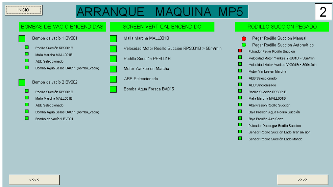
Figura Nº 2.45 Secuencias de encendido de las BOMBAS DE VACIO, SCREEN VERTICAL y RODILLO DE SUCCION PEGADO
