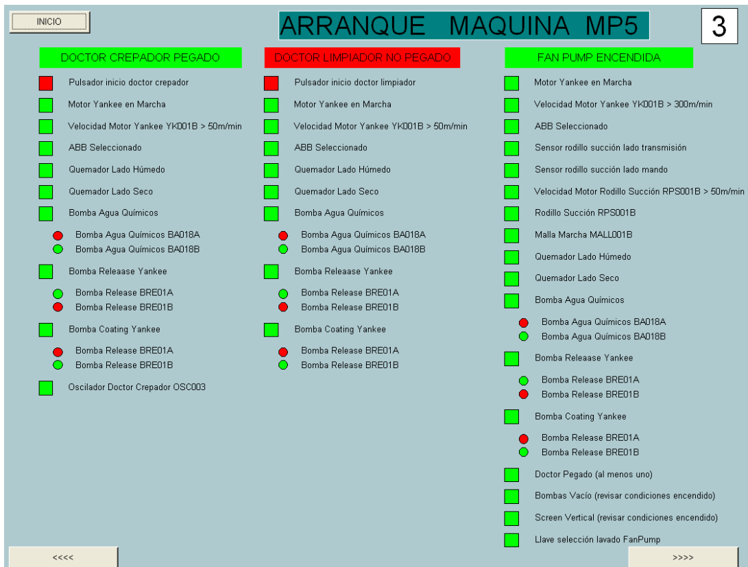
Figura Nº 2.46 Secuencias de encendido de DOCTOR CREPADOR PEGADO, DOCTOR LIMPIADOR NO PEGADO, FAN PUMP
