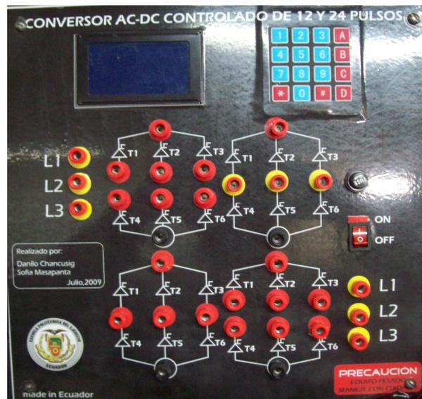
Figura 2.41 Vista frontal del módulo conversor AC/DC controlado.
