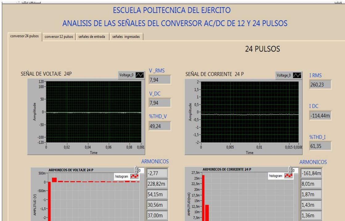
Figura 2.31 Panel frontal del analizador de armónicos
