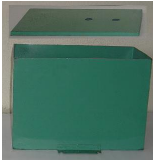
Fig. 6.6. Tanque de Combustible
