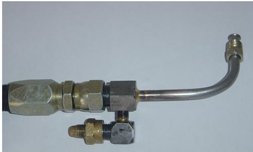
Fig. 6.9. Acoples de la salida de combustible hacia el
