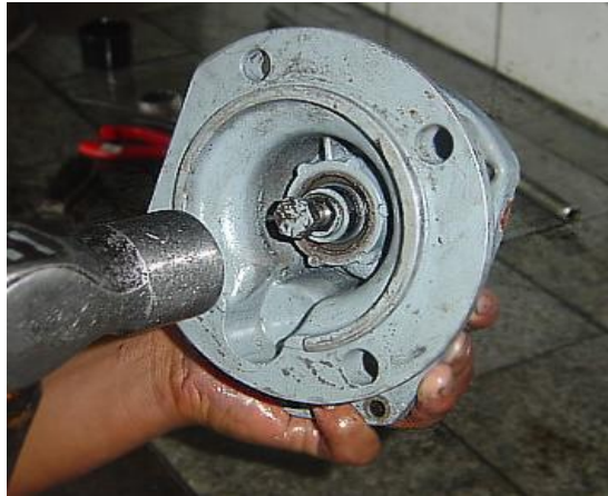
Fig. 9.41. Remoción del Eje o Flecha Principal
