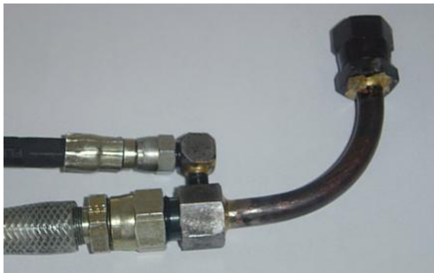
Fig. 6.12. Acople de entrada de combustible del
