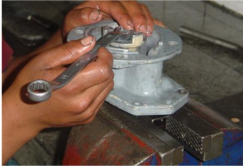
Fig. 9.44. Armado de la Tapa de Impulsión
