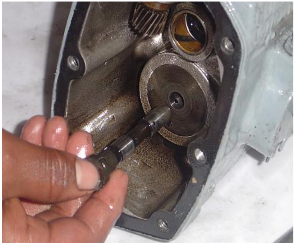
Fig. 9.35. Extracción del Émbolo del Gobernador
