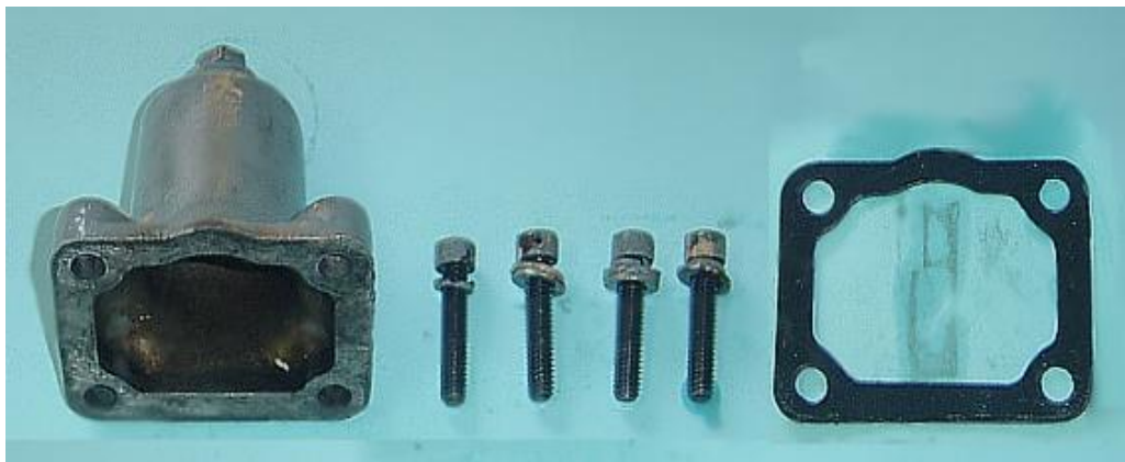
Fig. 9.12. Vista de la Tapa del Grupo de Resortes
