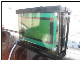
Figura 2. Pantalla GLCD montada sobre el tablero del vehículo
