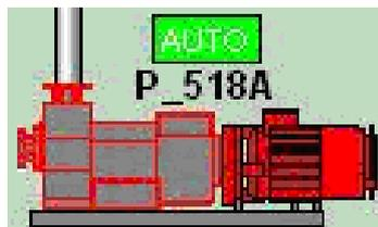
Cuando el selector HoA de los arrancadores ubicados en el MCC de la estación de reinyección, se encuentra ubicado en la posición Automático, las bombas pueden ser operadas en modo Operador/Secuencia.
