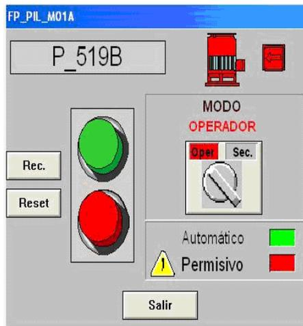
Cuando trabajamos en modo Secuencia las bombas serán controladas por los niveles de los tanques Alto Alto para arrancar y Bajo Bajo para parar la bomba.
