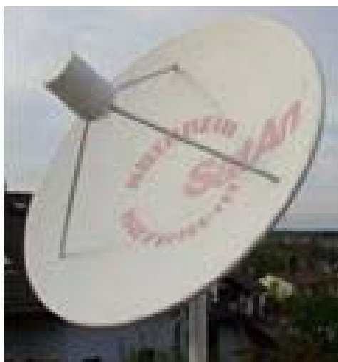
Figura 2.38. Antena con Reflector
