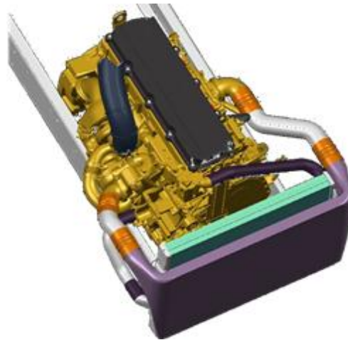
Figura N.º 2.3 Sistema de Refrigeración por Aire
