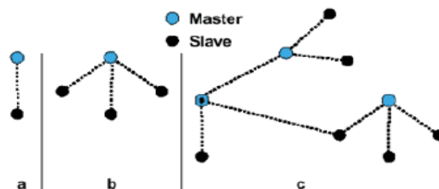
Figura 1.19: Piconet con un solo esclavo (a), con múltiples esclavos (b) y scatternet (c)
