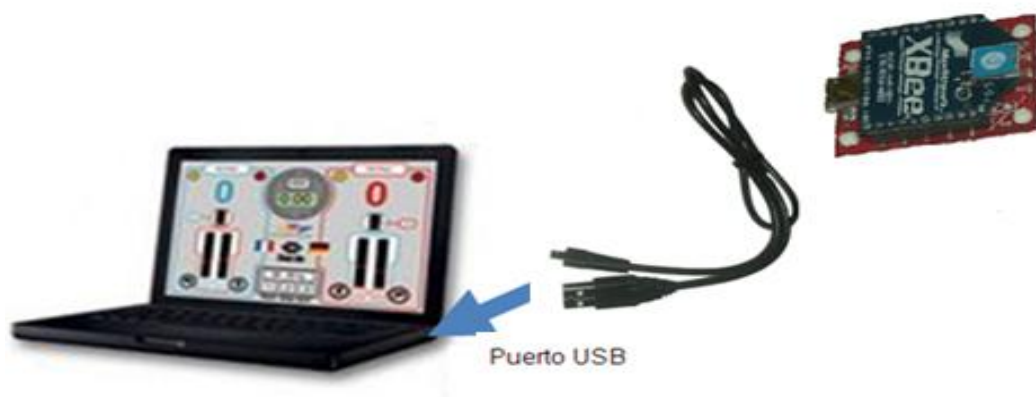
Figura 4.24: Procedimiento de Conexión Módulo Máster y PC
