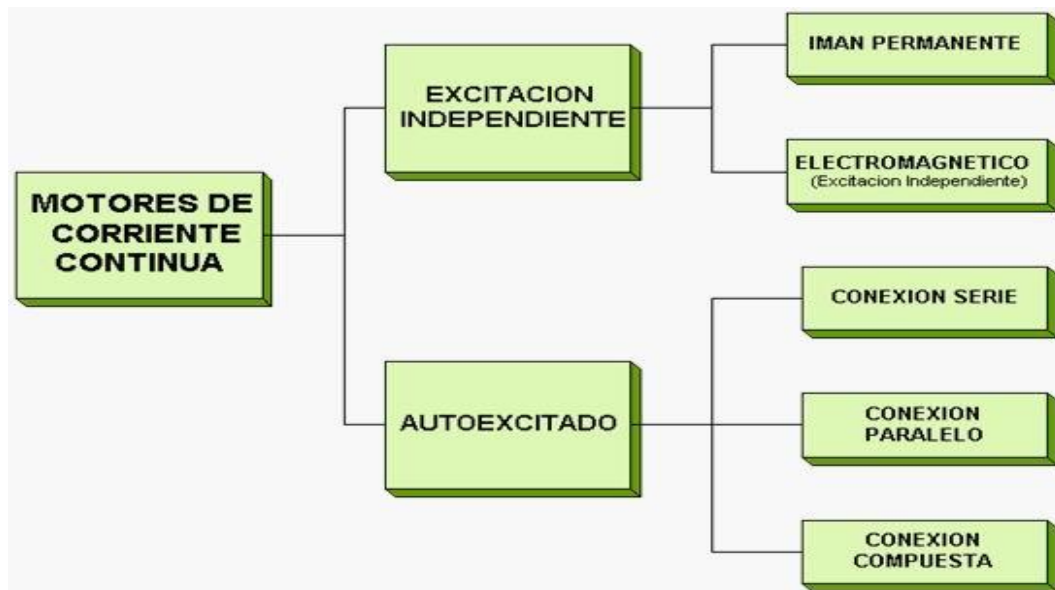
Fig.1.12 Cuadro sinóptico de los motores DC
