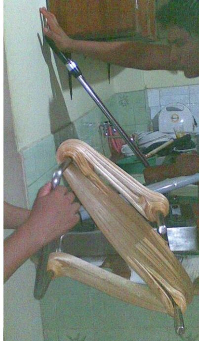
Figura 2.27 Medición de torque en brazos amasadores.
