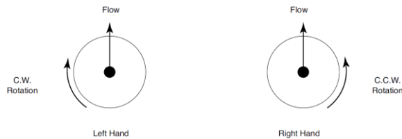
Figura 2.37 Rotación de un transportador helicoidal
