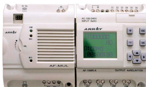
Figura 2.89 PLC junto al Modulo de Voz
