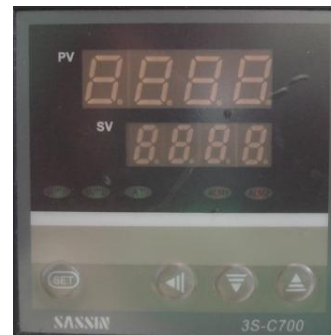
Figura 2.84 Controlador de temperatura
