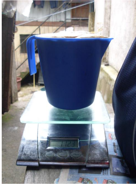
Figura 2.6 Lectura de peso para cálculo de densidad
