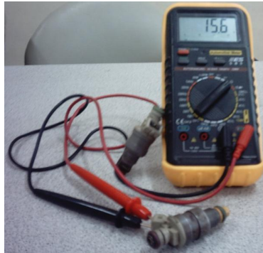
Figura 1.23 Medición de Resistencia del Inyector
