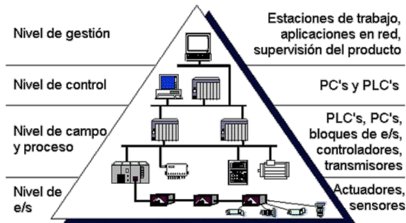
Figura 3.16. Estructura jerárquica de una Red Industrial
