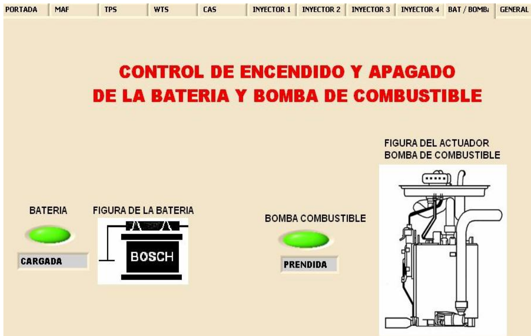
Figura 5.58. Pantalla Batería y Bomba de Combustible
