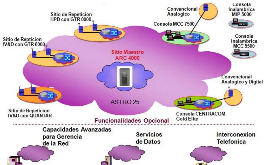
Figura 1.28 Red del Sistema Troncalizado ASTRO® 25 De Motorola
