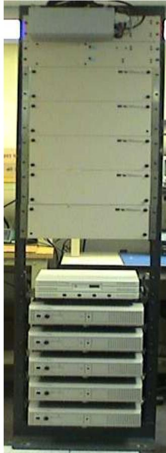
**Figura 1.18 Sistema Troncalizado SmartNet de 800Mhz. y 5 Repetidoras**
