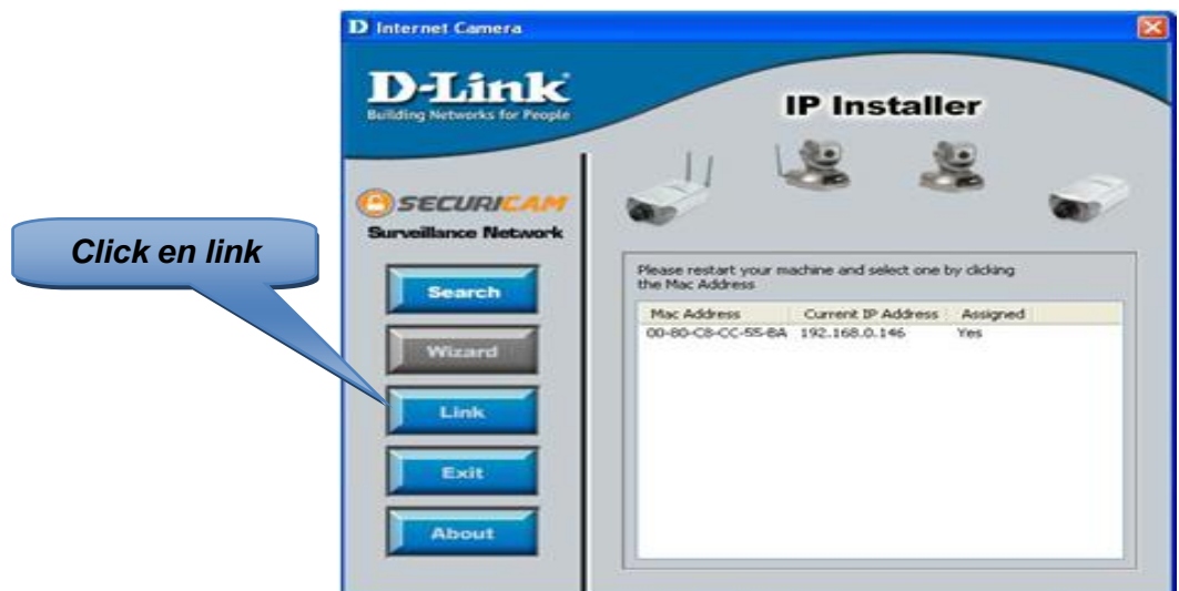
Figura N° 3.6 El Software muestra la dirección IP de la cámara
