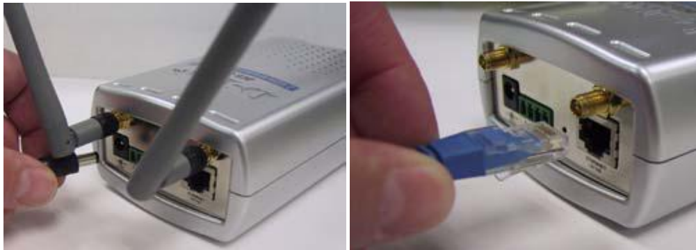
Figura N° 3.3 Montaje de la Cámara IP
