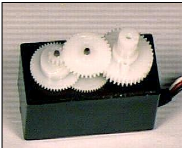
Figura N° 2.19. Detalle del tren de engranajes.
