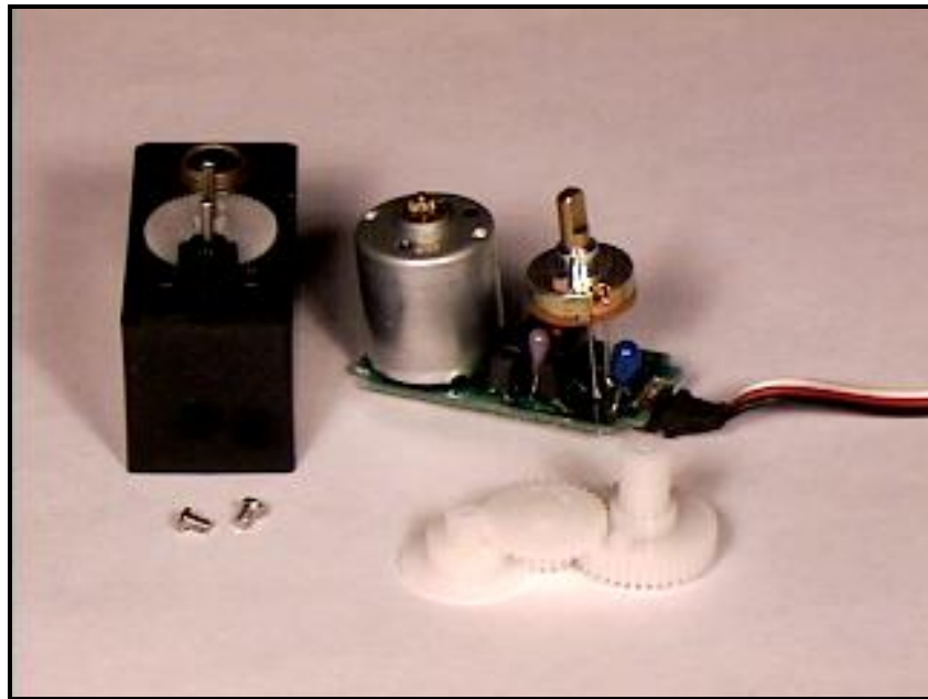
Figura Nº 2.17. Estructura interna de un servomotor.
