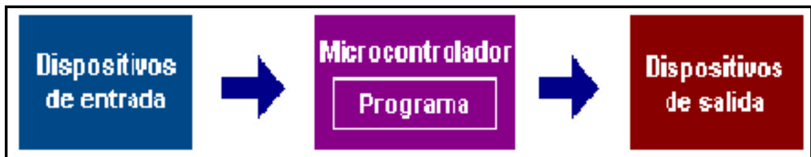
Figura Nº 2.38. Diagrama de bloques general de un PIC.
