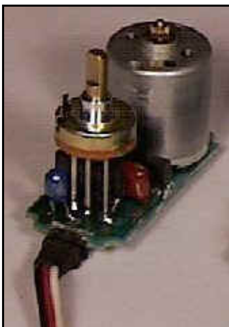
Figura N° 2.20. Detalle del circuito de realimentación.
