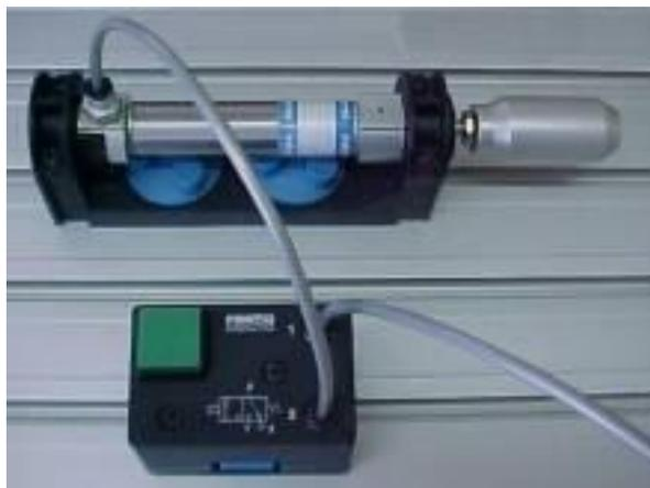
**Figura 1.51** Válvula 2/2 conectada a un cilindro simple efecto
