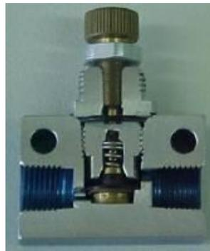
**Figura 1.61 Estructura física de una válvula de caudal**
