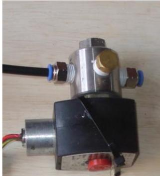
**Figura 2.31 Electroválvula para el paso de líquido**
