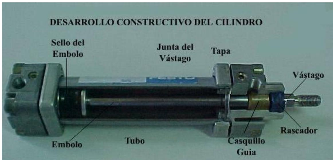
**Figura 1.65 Partes de un cilindro.**
