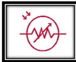
Figura N° 1.25 Símbolo de una fotorresistencia
