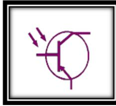
**Figura Nº 1.32 Símbolo de un Fototransistor**
