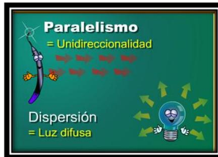
Figura Nº 2.6 El láser es una luz pasible de sufrir colimación, o sea, camina de manera “paralela”, distinto de la luz común que se pierde en el tiempo y en el espacio.
