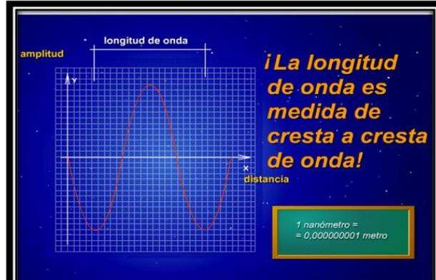
Figura Nº 2.3 Mensuración de la longitud de una onda electromagnética.
