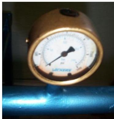
**Figura 4.4 Acople del Medidor de Presión**
