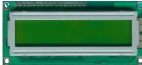
**Figura 3.2 Fotografía de un LCD**
