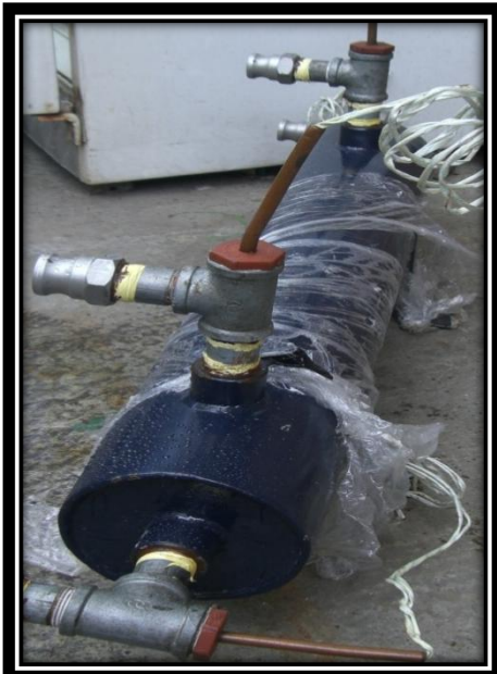
Figura 3.11 Gráfica y esquema del I.C. multitubo contraflujo
