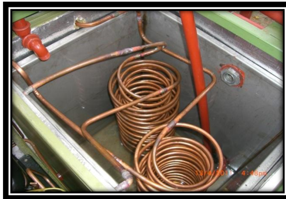
Figura 2.66 Evaporador y tanque de almacenamiento de agua
