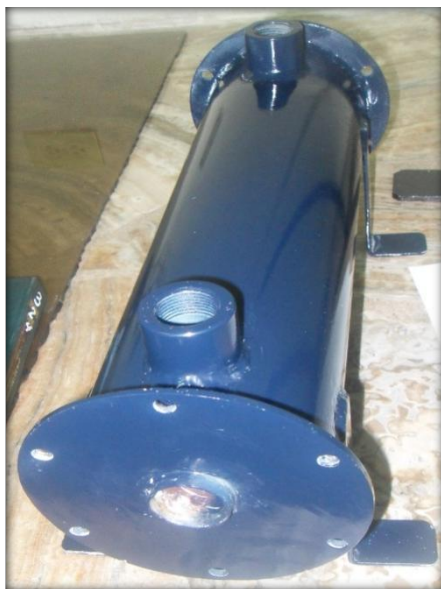
Figura 3.8 Gráfica y esquema del I.C concéntrico contraflujo
