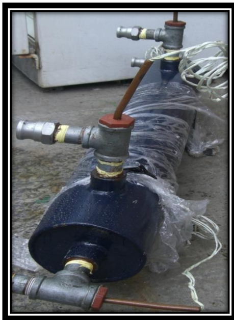
Figura 3.13 Gráfica y esquema del I.C. multitubo flujo paralelo
