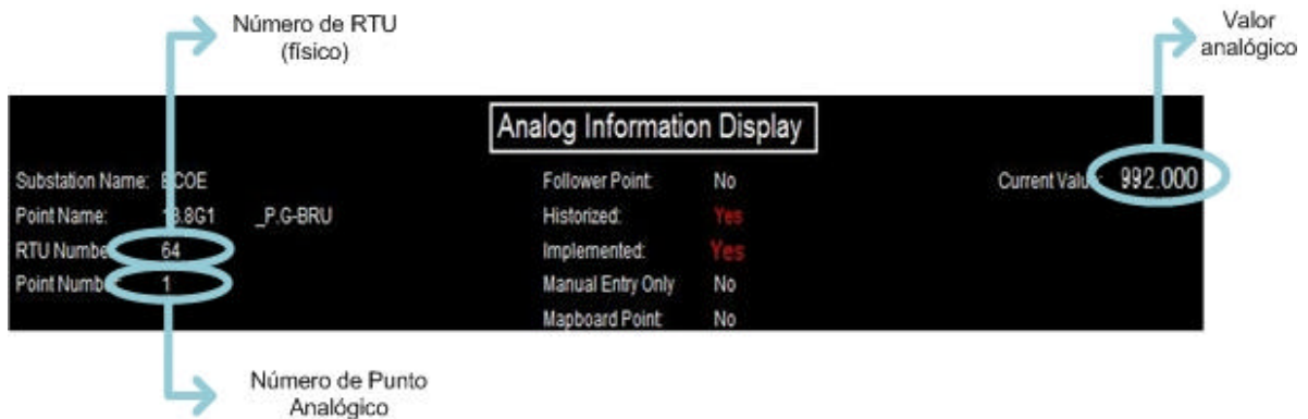
Figura 5.27 Descripción de la adquisición de la señal analógica
