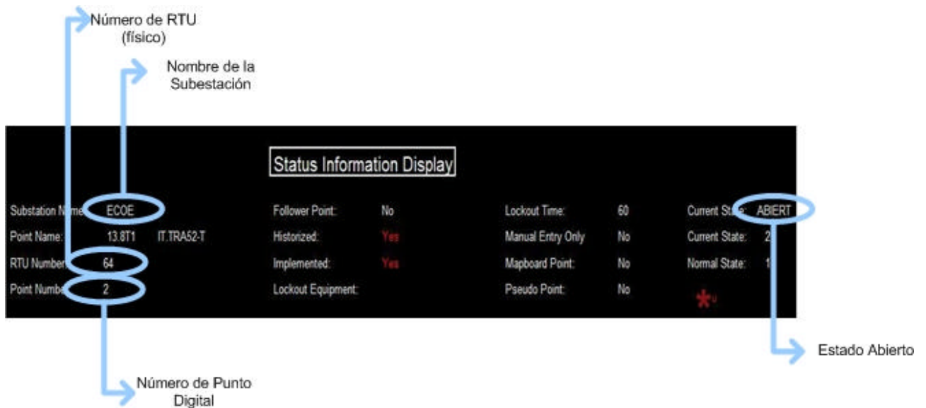
Figura 5.6 Descripción de la adquisición de la señal digital
