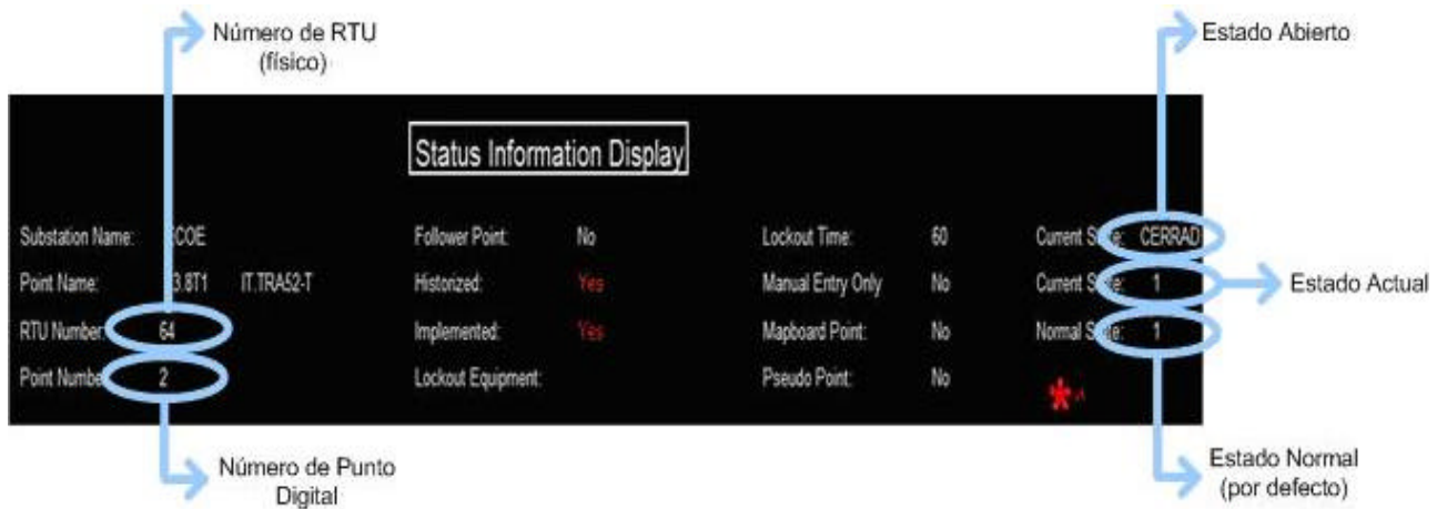
Figura 5.33 Descripción de la adquisición de la señal digitales doble (estado cerrado)
