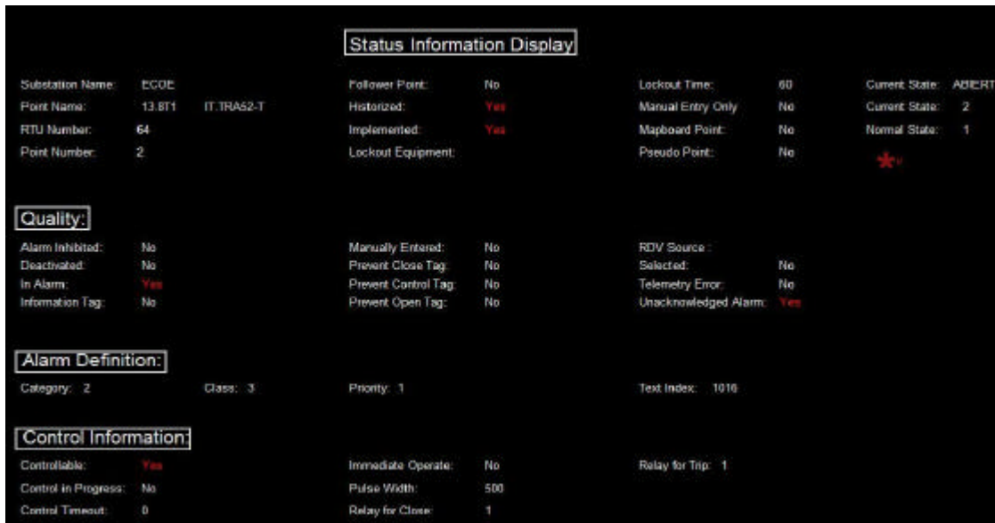
Figura 5.18 Adquisición de señales por el Sistema Network Manager
