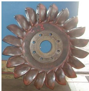
Es de admisión parcial, lo cual depende del número de chorros o de inyectores. Consta de un disco previsto de una serie de cucharas montadas en su periferia. Las cucharas pueden estar empernadas al disco, unidas por la soldadura o fundidas en una sola pieza este ultimo son las que dispone la central Illuchi 1. la turbina pelton puede instalarse con el eje horizontal con uno o dos inyectores y con el eje vertical con tres a seis inyectores.
